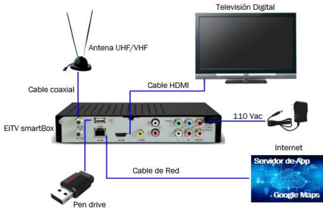
Figura 1. Diagrama de instalación
