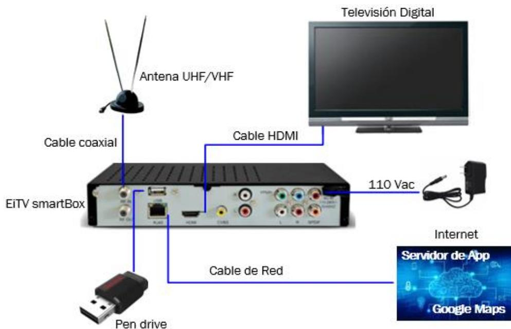
Figura 4. 24. Diagrama de conexiones
