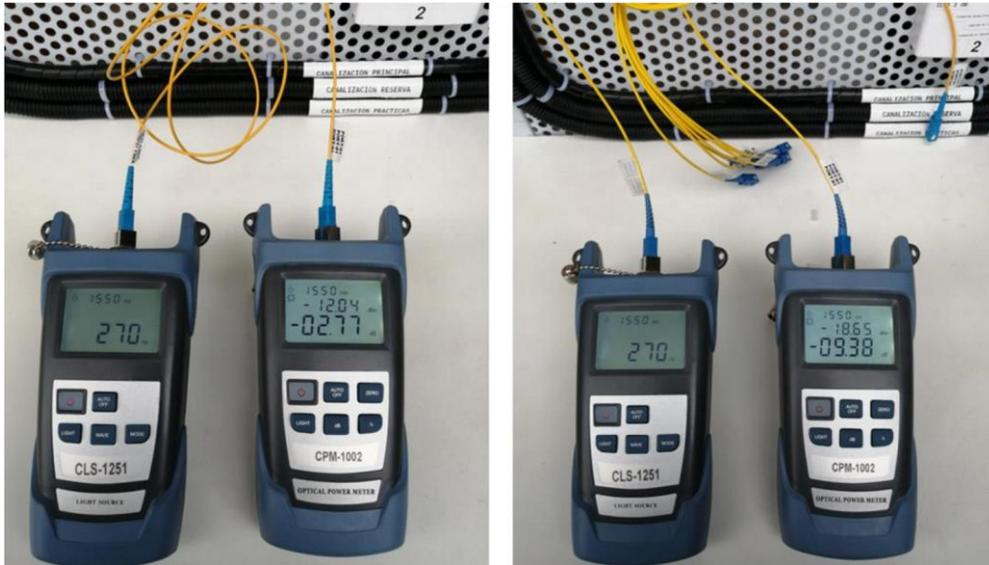
**Figura 4.33** Pruebas de medidas de potencia en *splitter*
