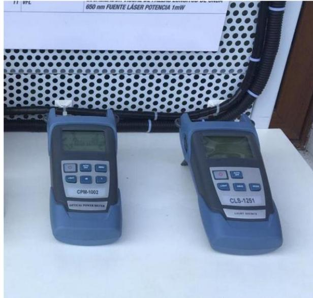
**Figura 4.27** Equipos para medir potencia
