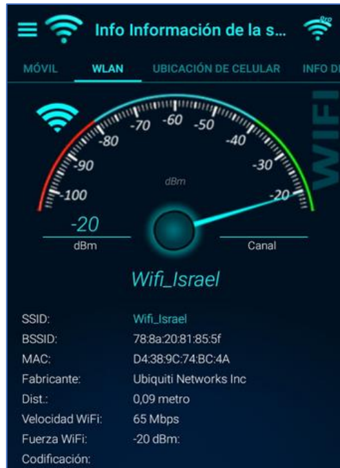
Figura 17 Potencia y distancia del Router.
