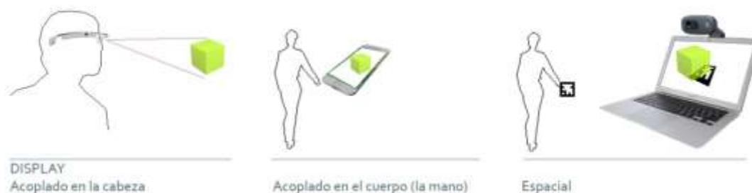
Figura 5. Variantes de componentes display de RA
