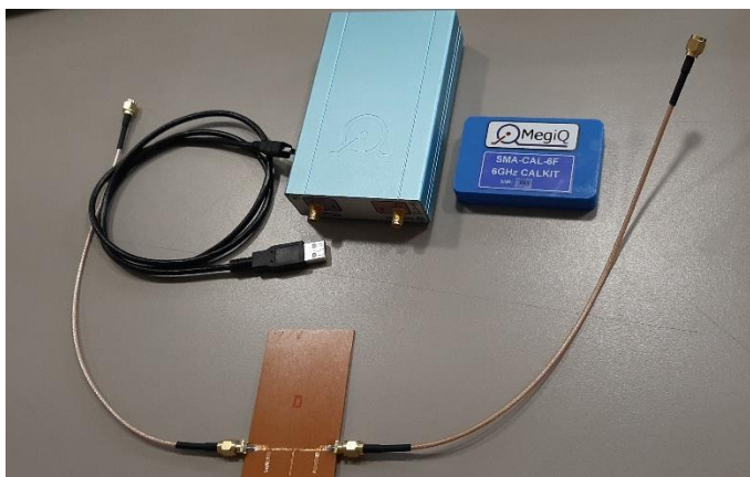
Figura. 4.12. VNA con su kit de calibración y filtro a medir Fuente: Elaborado por el autor
