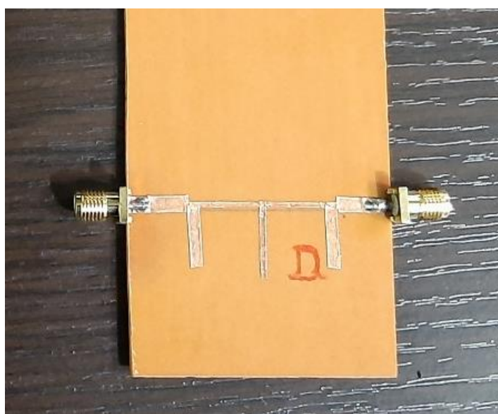
Figura. 4.6. Prototipo realizado con cinta de cobre Fuente: Elaborado por el autor
