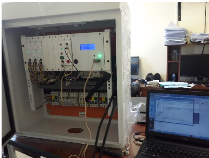
Figura 4.7. Transferencia del programa al controlador de tráfico. Fuente: Elaborado por el autor.
