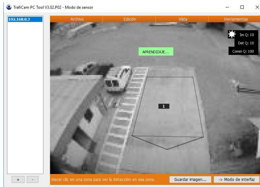
Figura 4.18. Modo aprendizaje de la cámara TafiCam. Fuente: Software TafiCam PC Tool.
