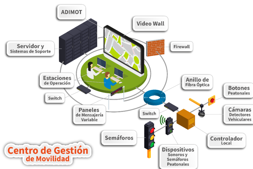
Figura 1.7. Esquema de un centro de gestión de movilidad. Fuente: (Avante, 2017).
