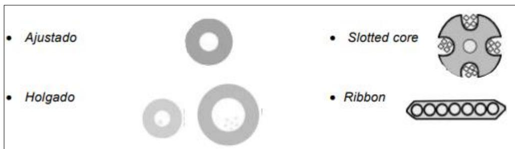
**Figura. 1.16. Estructura de los cables de fibra óptica**
