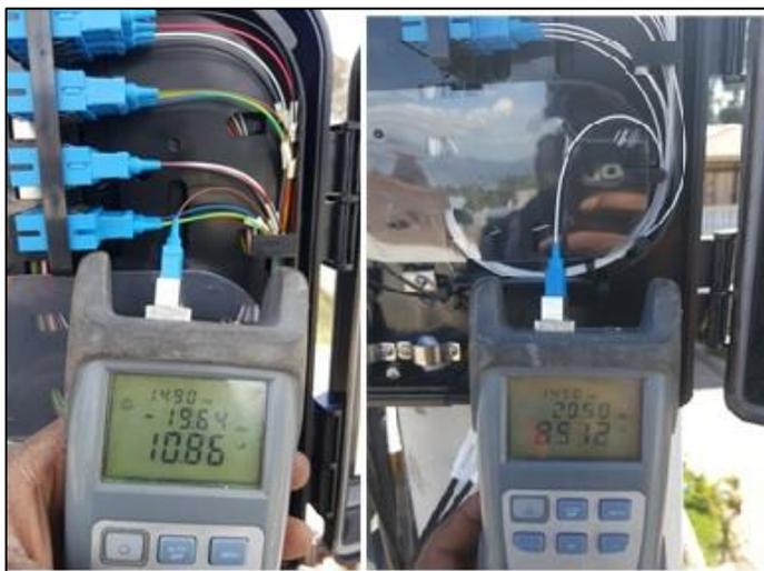
**Figura. 4.30. Medición de potencia en cajas de distribución óptica (QSD 0014 y QSD 0015)**
