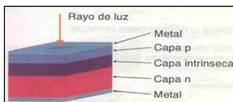
**Figura. 1.27. Composición fotodetector PIN**
