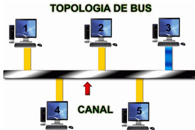
Figura 1.5 Topología tipo bus Fuente: (Topologías de Red, 2019)
