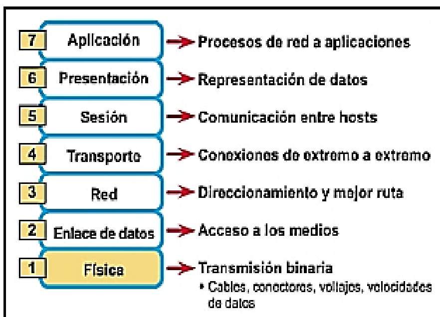
Figura 1.9 Las capas del modelo OSI Fuente: (UNICEN, 2016)
