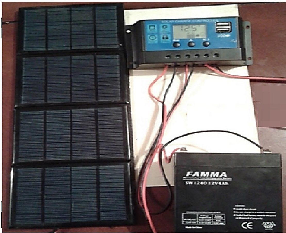
Figura 4. 21. Conexión y comprobación del sistema de carga. Fuente: Elaborado por el autor.
