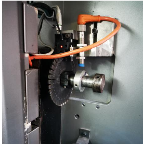
Figura 53 sensor de sincronización de la máquina (El Autor 2019)
