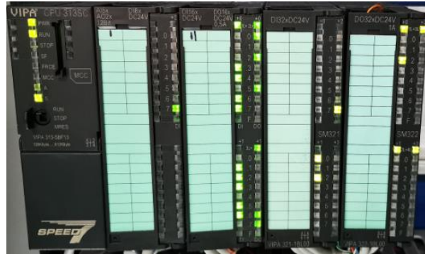
Figura 43 PLC Marca Vipa (El Autor 2019)
