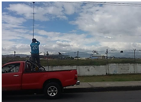
Figura 4. 28 Medición de campo con antena patrón a 9m de altura
