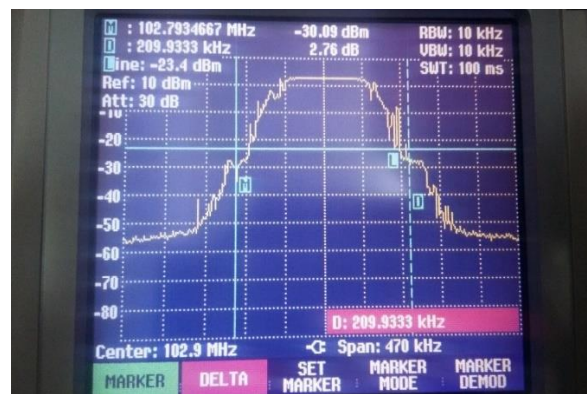
Figura 4. 25 Ancho de banda en 210KHz
