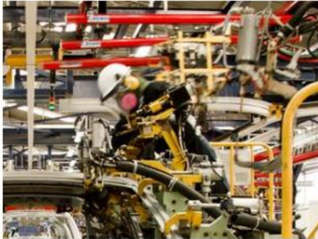
Figura 19: Operador en proceso de soldadura
