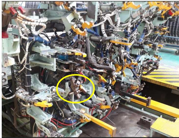
Figura 22: Pistolas fijas de soldadura
