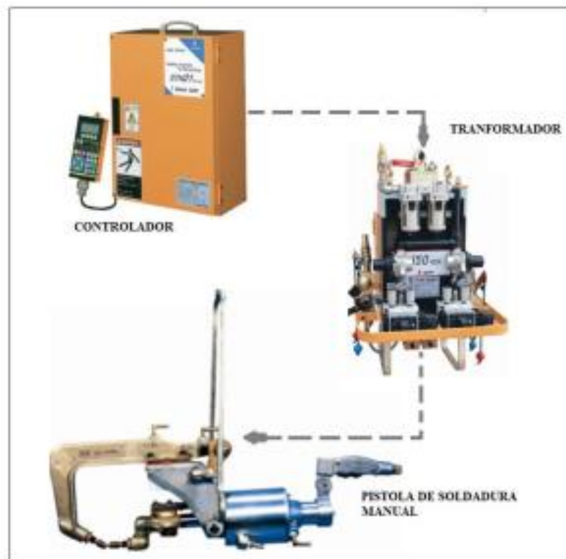
Figura 20: Elementos soldadura manual OBARA
