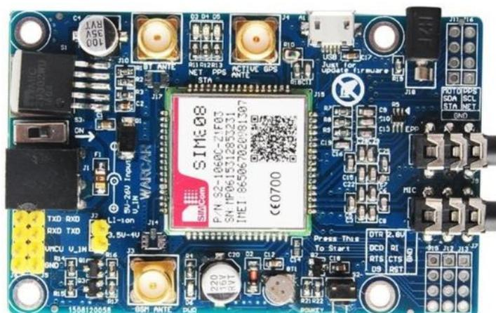
Figura 1.2 Módulo SIM808 GSM/GPS
