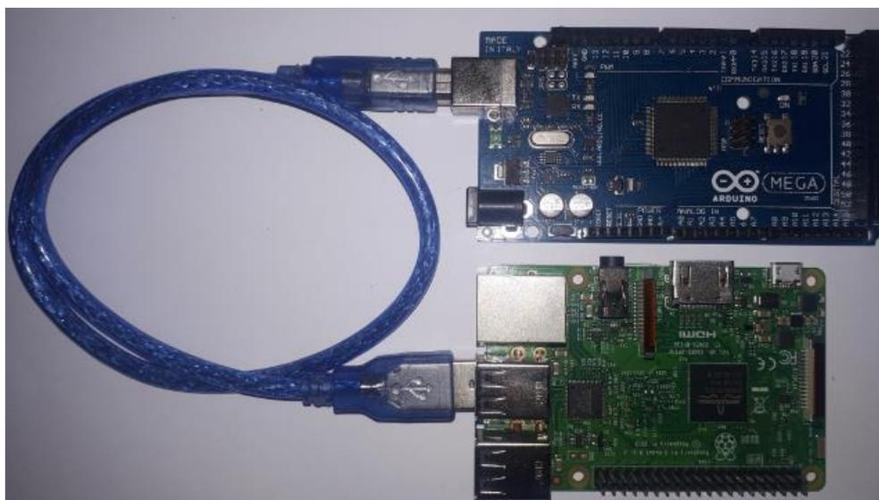
**Figura 4.52** Conexión serial entre Arduino y Raspberry PI
