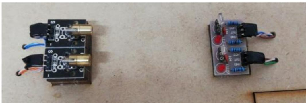
**Figura 4.49** Instalación de módulo laser (transmisión y recepción)
