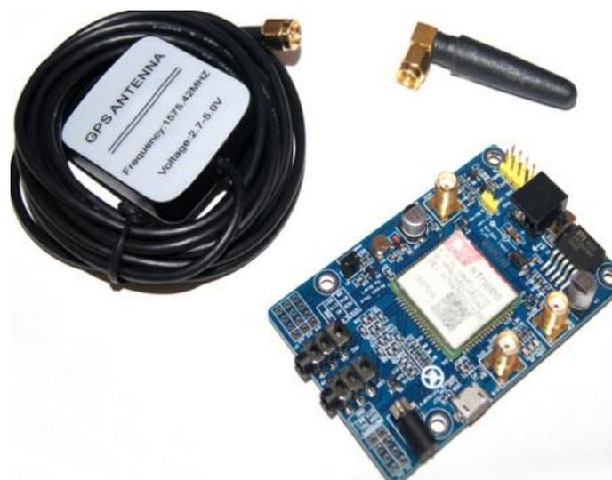
Figura. 0.11 Módulo SIM808 GSM/GPS
