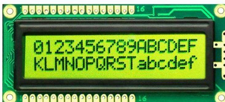
**Figura 1.7** *Display LCD 16x2*
