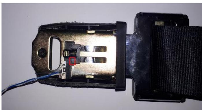
**Figura 4.44 Instalación de final de carrera en cinturón de seguridad**
