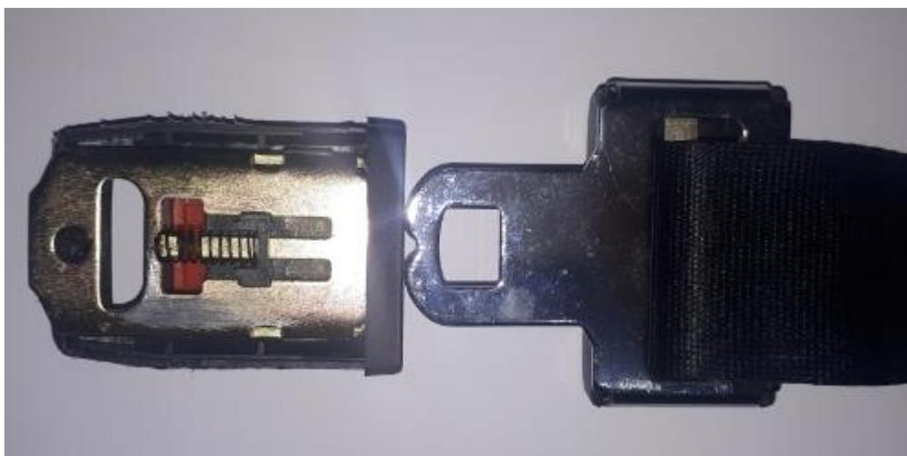
**Figura 4.42** Cinturón de seguridad desarmado
