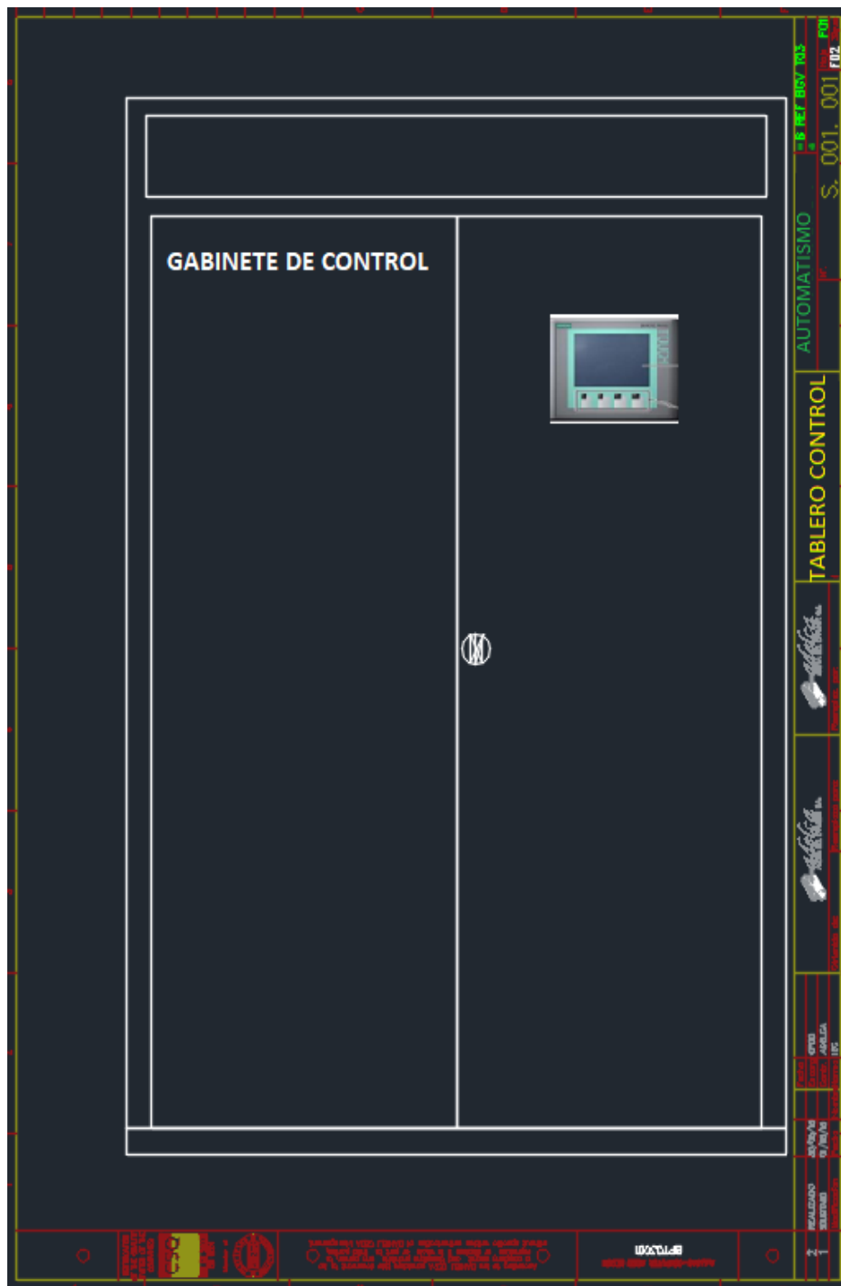
Figura 3.314. Estructura gabinete de control de señales Fuente: Elaborado por el autor.
