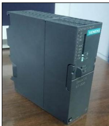
Figura 1. 15. PLC, Compacto Siemens S7 Fuente: Elaborado por el autor
