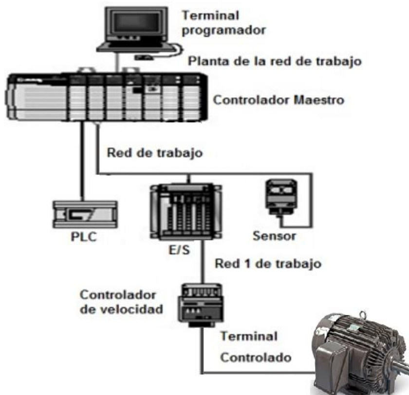
Figura 1. 14. Estructura del PLC Fuente: Elaborado por el autor.
