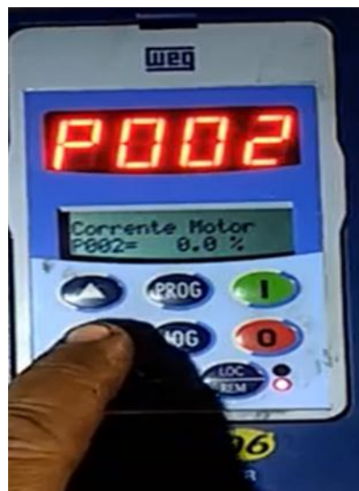
Figura 4. 57. Parametrización corriente del motor Fuente: Elaborado por el autor. (2018)
