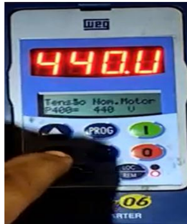
Figura 4. 58. Parametrización de tensión. Fuente: Elaborado por el autor. (2018)
