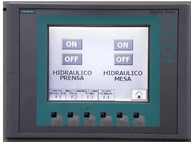
Figura 1.7: HMI marca siemens KTP 600
