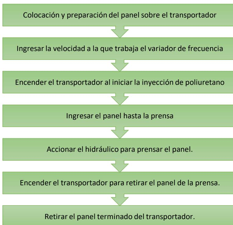
**Figura 3.1: Diagrama general transportador de paneles**
