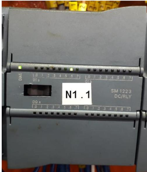
Figura 1.6: Módulo de entradas y salidas DC / Relay
