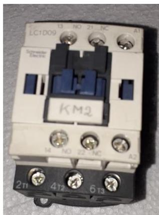
Figura 1.18: Contactor trifásico.
