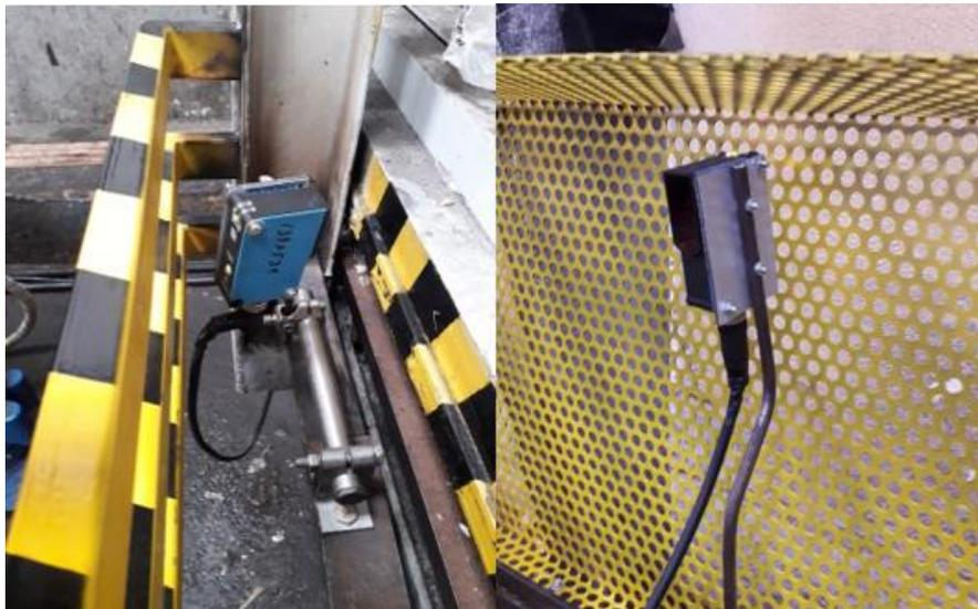
**FIGURA 3: Sensores fotoeléctricos del transportador**
