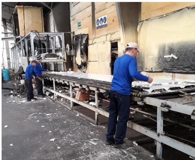
**Figura 3.2: Preparación de paneles antes de la inyección de poliuretano**
