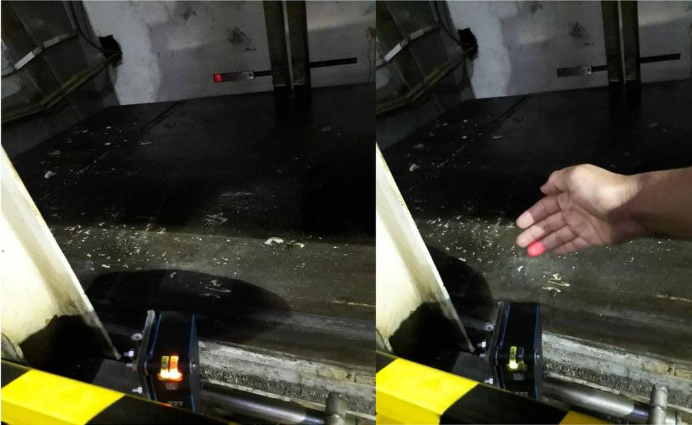
**Figura 4: Prueba de funcionamiento de sensores fotoeléctricos**
