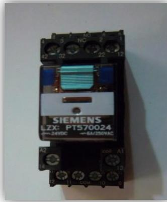
Figura 1.17: Relé marca siemens de 24 VAC
