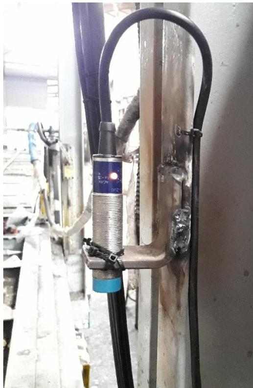
**Figura 9: sensor inductivo que detiene el hidráulico de la prensa**
