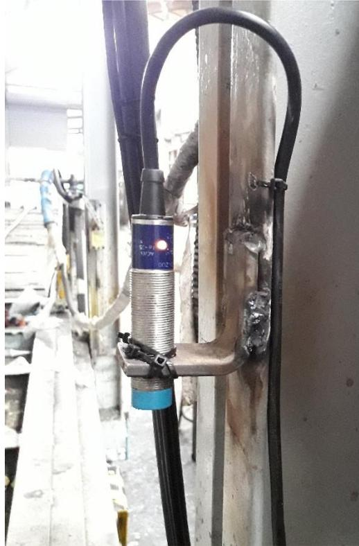
**Figura 3.7: sensor inductivo que detiene el hidráulico de la prensa**
