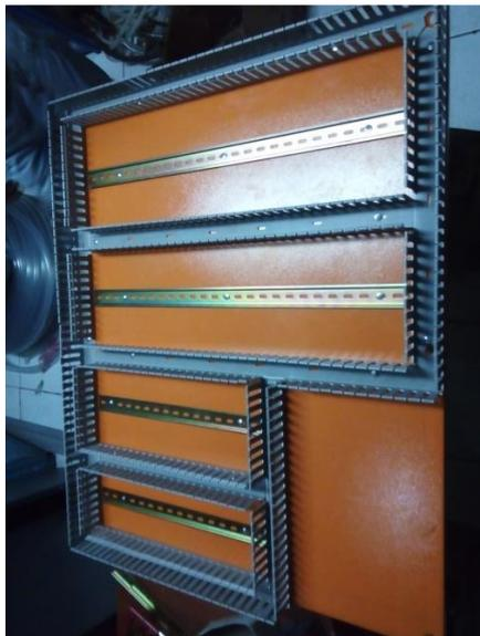
**Figura 4.2:** Colocación de canaleta y riel din sobre el doble fondo
