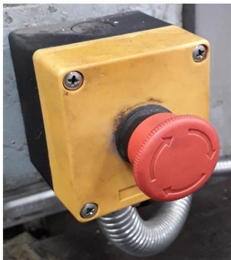
**Figura 1.11: Paro de emergencia transportador de paneles**
