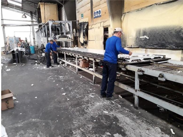
**Figura 5: Preparación de paneles antes de la inyección de poliuretano**
