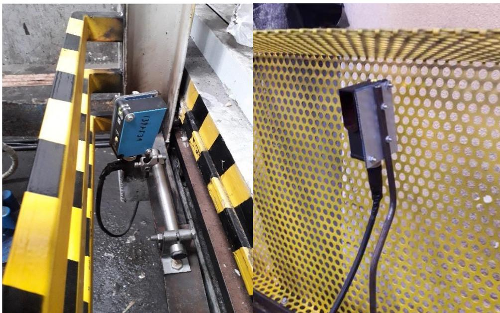
**Figura 4.4: Sensores fotoeléctricos que detectan la presencia del transportador**
