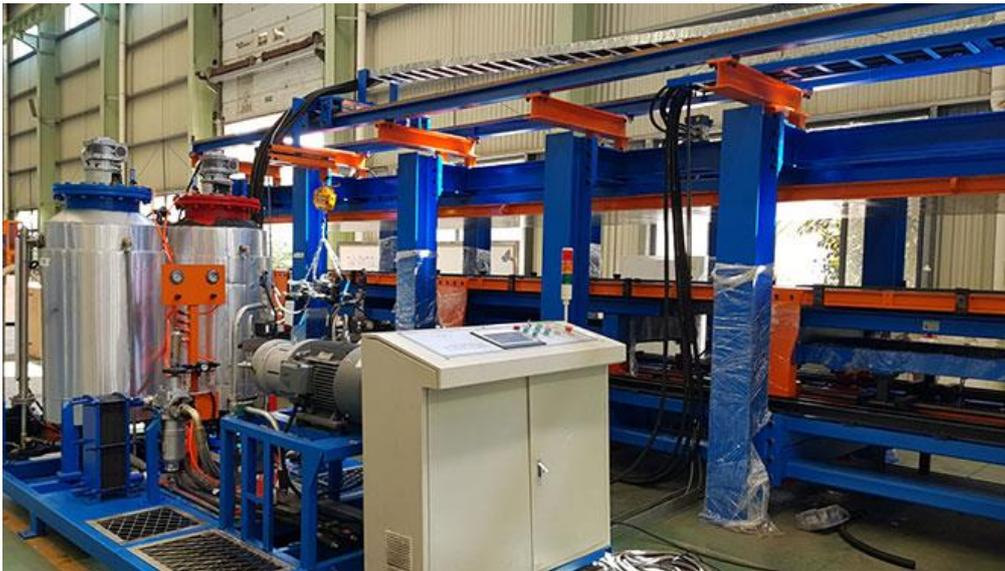
**Figura 1.1: Máquina para el transporte y prensado de paneles**
