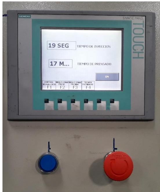
**Figura 8: Ingreso de tiempo de inyección y tiempo de prensado**
