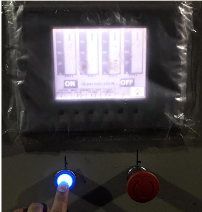
**Figura 12: Pulsador 4 para resetear el equipo.**
