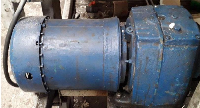
**Figura 1.10: Motor trifásico de 5 HP transportador de paneles**
