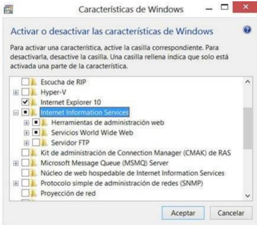
**Figura 6.** Pantalla de instalación de IIS revisando características
