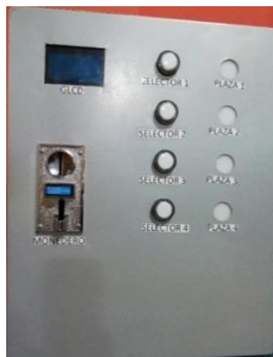
Figura 4-10: Montaje de los dispositivos en la parte delantera
