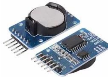
Figura 3-10: Módulo de reloj DS3231 Fuente: (García González, Navarro, & Montenegro, 2013)
