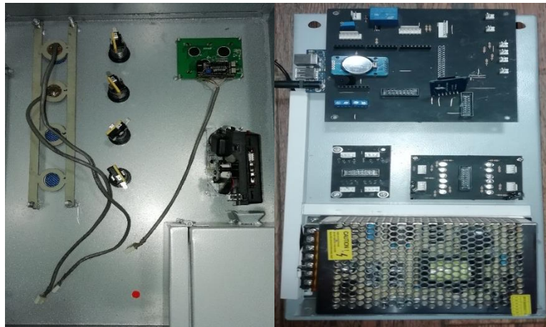
Figura 4-9: Montaje de PCB y actuadores
