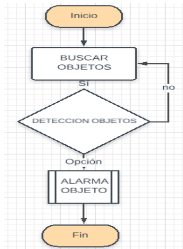
Figura 3-7: Diagrama de flujo del sensor HC-SR04 Fuente: Elaboración propia
