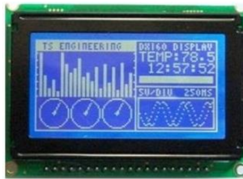
Figura 3-8: Display GLCD 128x64 Fuente: (García González, Navarro, & Montenegro, 2013)
