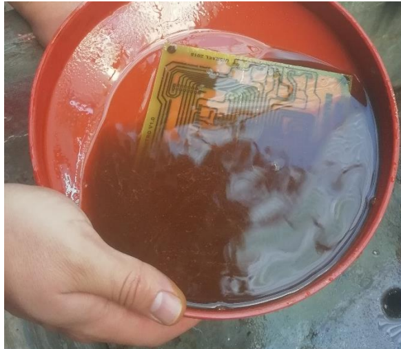
Figura 4-4: Retiro de la impresión de las pistas. Fuente: Elaboración propia
