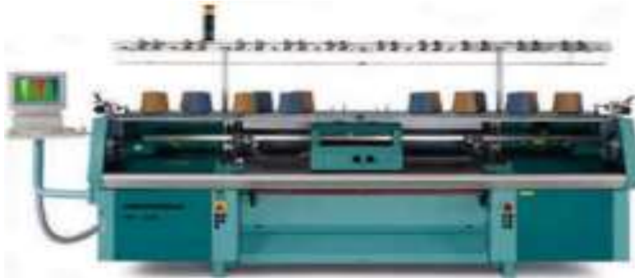
Figura. 1. 10. Máquina rectilínea tricotosa alemana marca Universal
