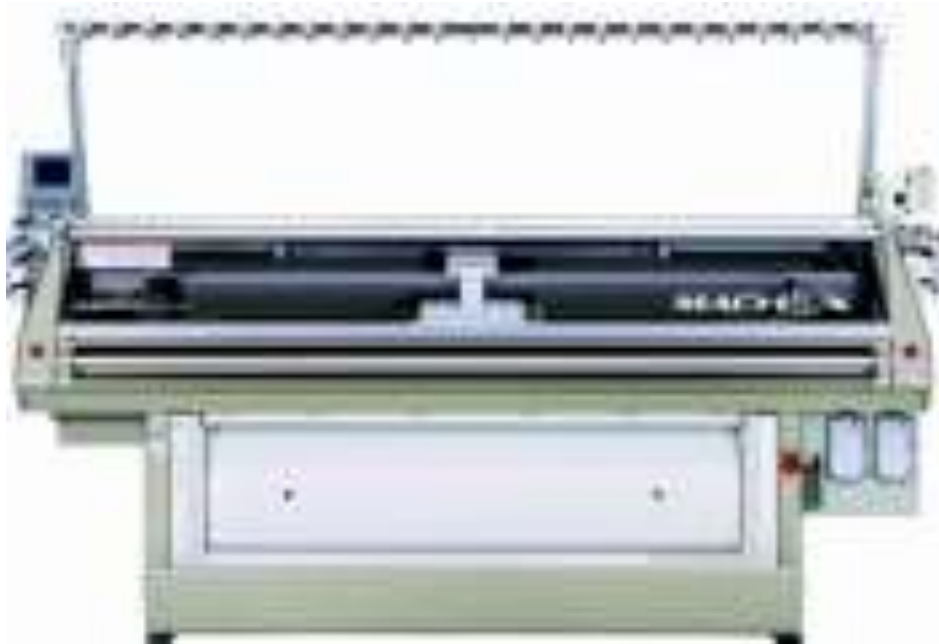
Figura. 1. 8. Máquina rectilínea tricotosa japonesa marca Shima Seiki
