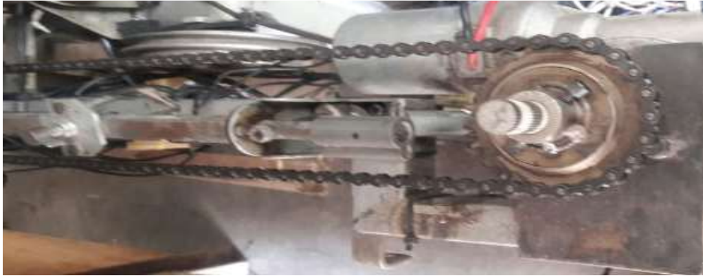
Figura. 4. 2. Instalación del sistema de cadena
