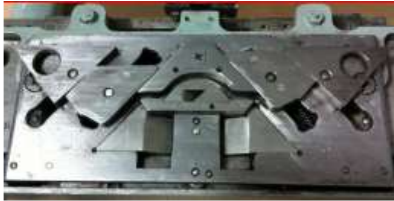
Figura. 1. 5. Levas o cerrojos de una máquina manual
