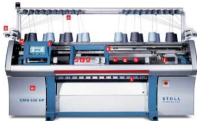
Figura. 1. 7. Máquina rectilínea tricotosa alemana marca Stoll modelo CMS 530HP
