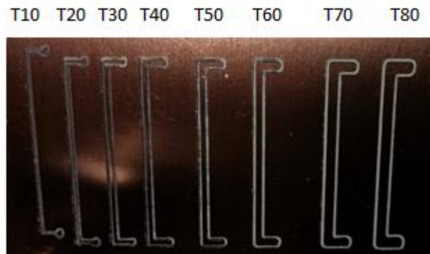
Figura 51: PCB obtenida de la fresadora CNC.
