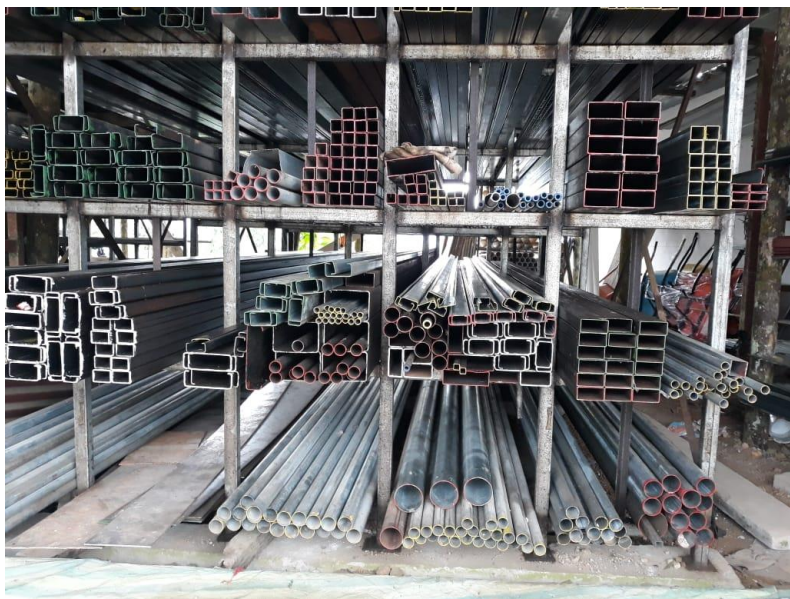
GRÁFICO 17 Percha de tubería estructural.
