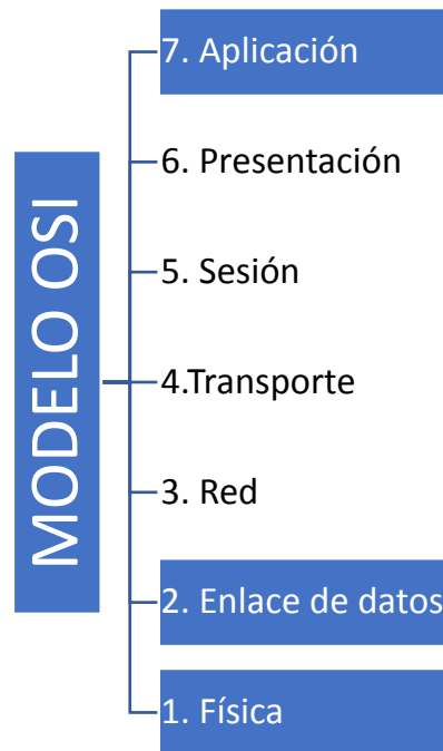
Figura. 1. 2. Capas del Modelo OSI para MODBUS RTU
