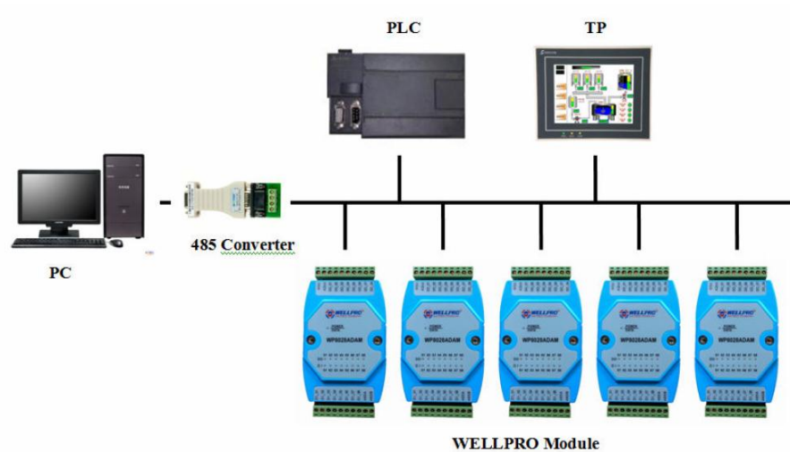
Figura. 1. 4. Diagrama de la red RS485
