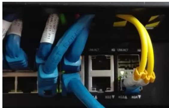
Figura 4.51 Conexión red en anillo b.
