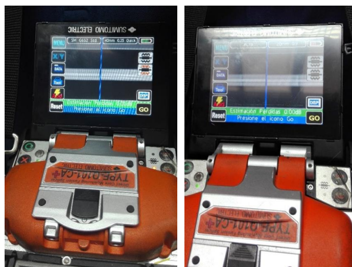
Figura 4.32 Empalmes de la fibra óptica.
