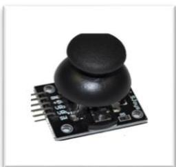
El módulo Arduino joystick trabaja con un voltaje de alimentación de 5V.
