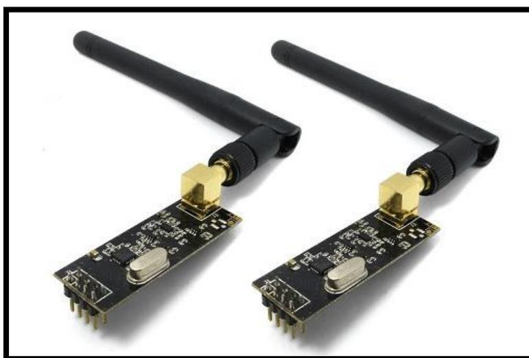
Figura. 1.4. Dispositivo NRF24L01
