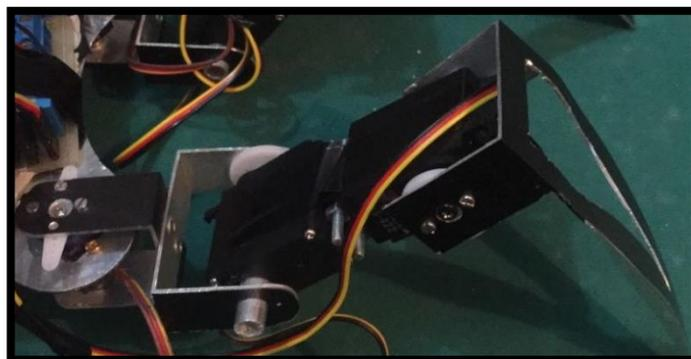
**Figura. 3.5. Ensamblaje de extremidades a torax**
