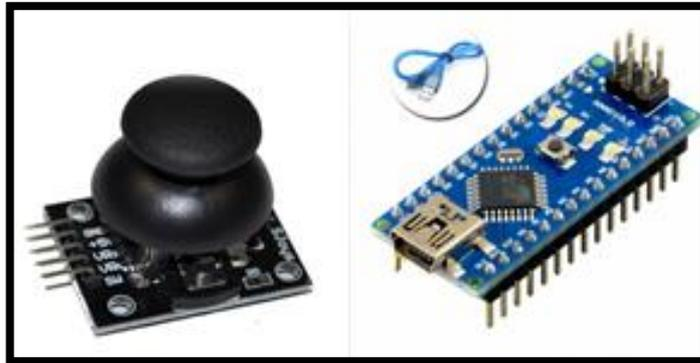
**Figura 3.6** Arduino Nano y Módulo Joystick
