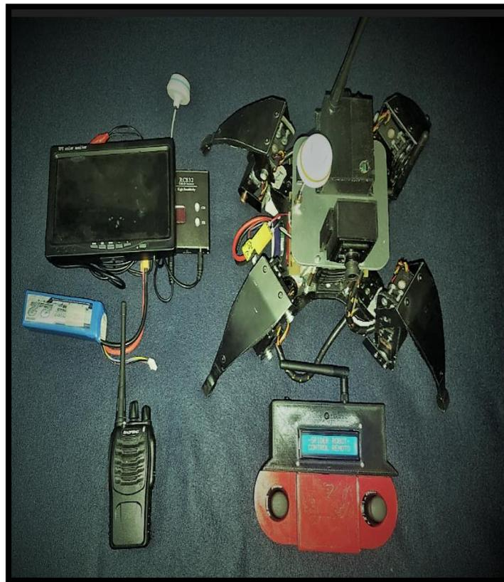
**Figura 1.1 Componentes Robot Cuadrúpedo**
