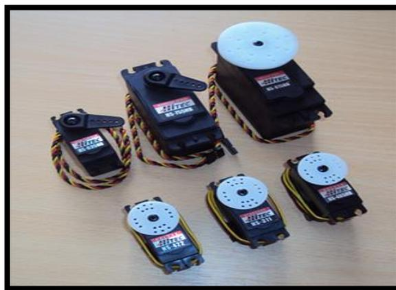
**Figura. 1.7. Servomotor y componentes**
