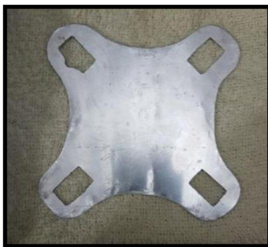
**Figura. 3.2. Piezas cortadas de robot cuadrúpedo**
