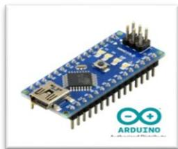
La placa Arduino Nano trabaja con un voltaje de alimentación de 7 a 12 Voltios.
