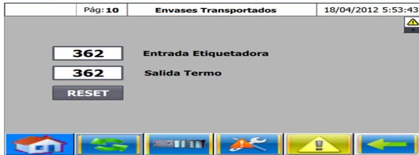
Figura 4.59. Contador de Producción
