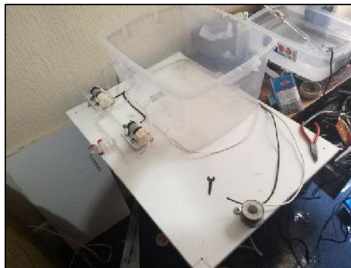
Figura. 4.5 Instalación de recipiente - integrado mini motores y tuberías de salida e ingreso
