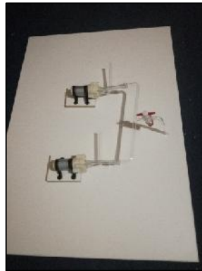
Figura. 4.4 Mini motores y tubería de salida elaborada con tubos de ensayo
