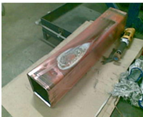
Figura 8 Lingotera retirada por mantenimiento.
