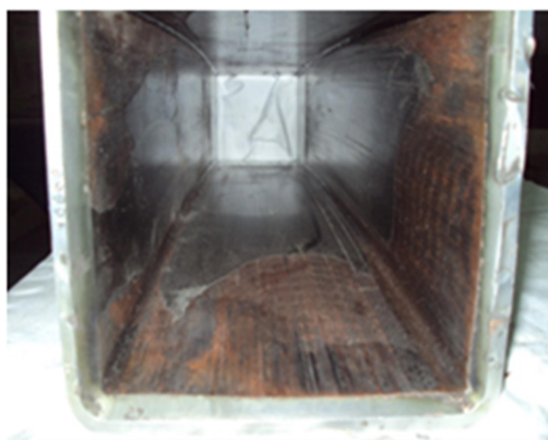
Figura 9 Interior de lingotera con desgaste de cromo.
