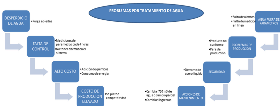
Figura 18 Problemas por tratamiento de agua en ADELCA
