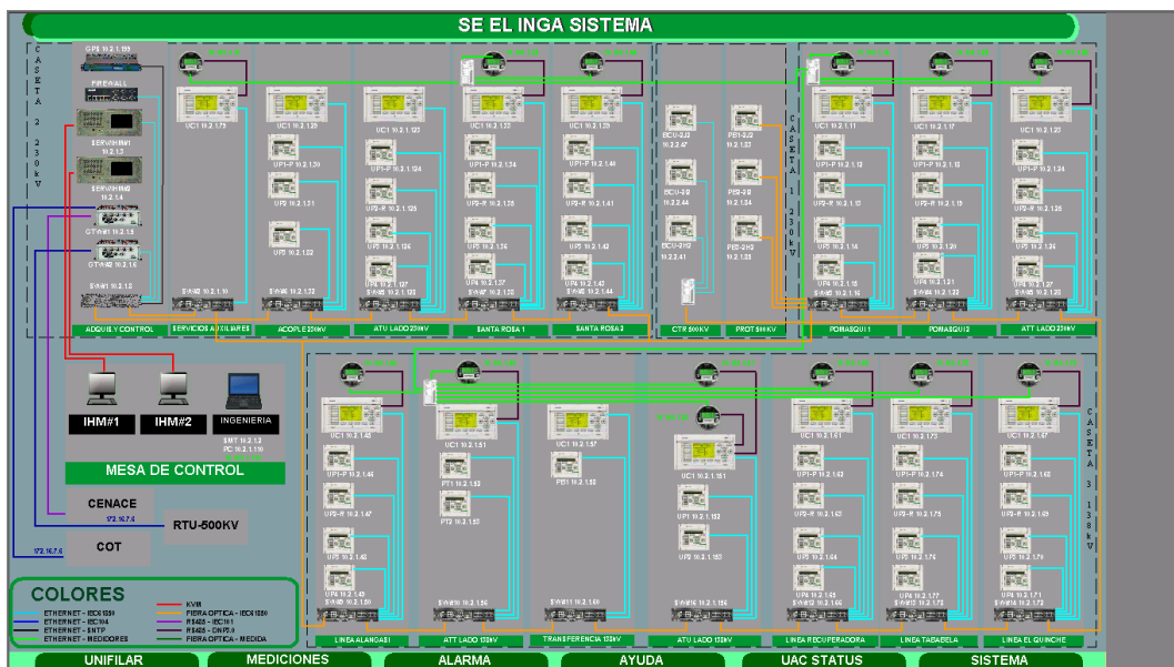
Figura 3. 15 Arquitectura del Sistema Subestación Inga
