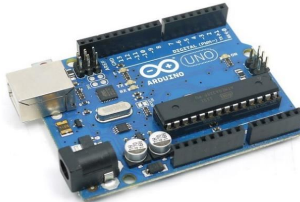
Figura 1.7 Placa Arduino Uno que incluye un microcontrolador de la marca Atmel ATmega328P, toda la circuitería de soporte, un reguladores de voltaje y un puerto USB que permite programar a la placa desde cualquier PC..
