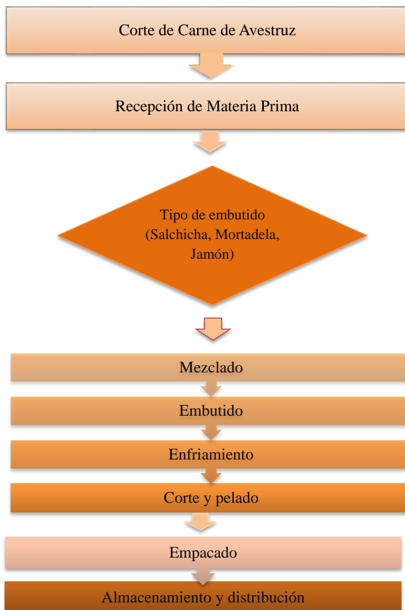
Figura N° 32 Proceso de Elaboración de embutido Elaborado: Autora
