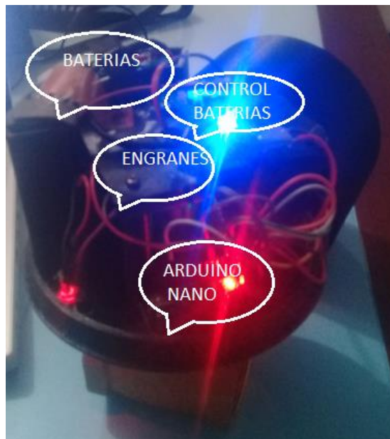
Figura. 7. Parte interna de la válvula
