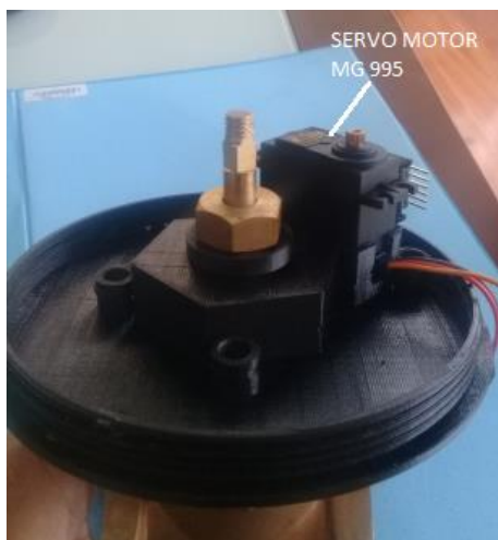
Figura. 4.33. Instalación de servomotor MG_995.
