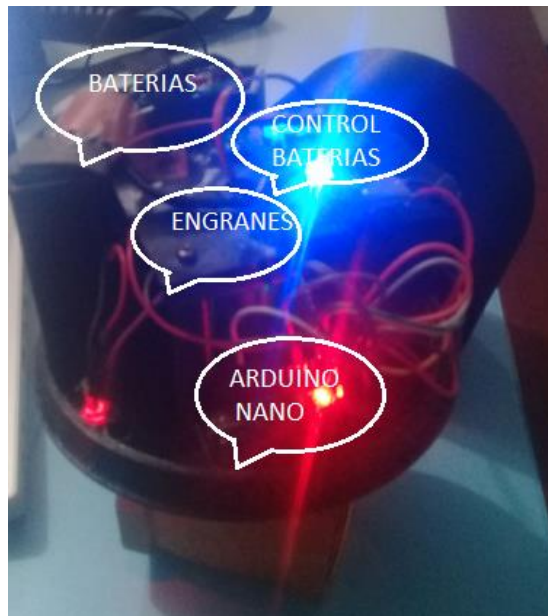
Figura. 0.1 Partes internas de la válvula
