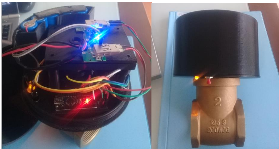
Figura. 4.43. Pruebas de encendido y apagado de la válvula
