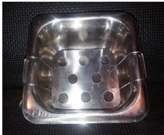
Figura 18. Bandeja y rejilla de alojamiento de inyectores expuestos al ultrasonido
