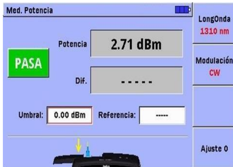
Figura 4.12 Potencia de TX (Upstream) de la ONT del cliente a 1310 [nm]
