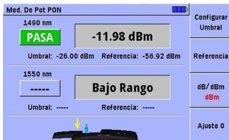
Figura 4.14 Potencia de RX (Downstream) de la ONT del cliente a 1490 [nm]
