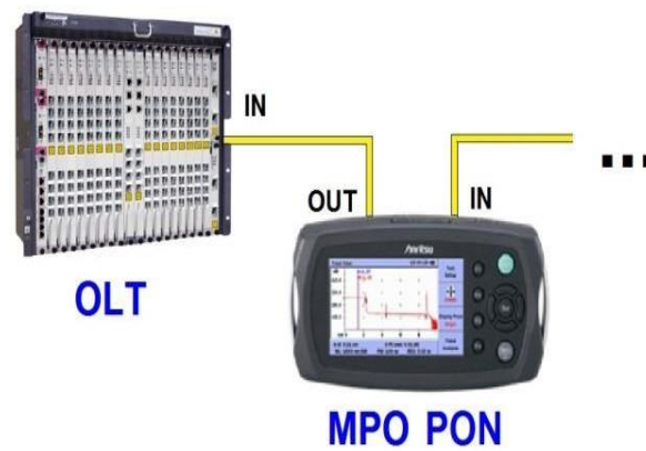
Figura 4.7 Configuración de conexiones para la prueba de RX del OLT
