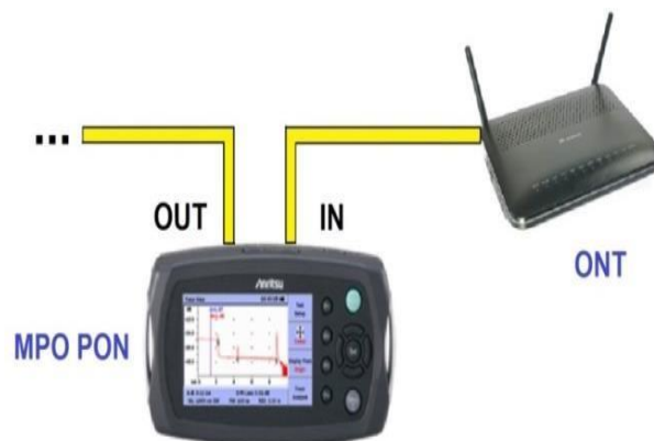
Figura 4.11 Configuración de conexiones para medir transmisión en ONT
