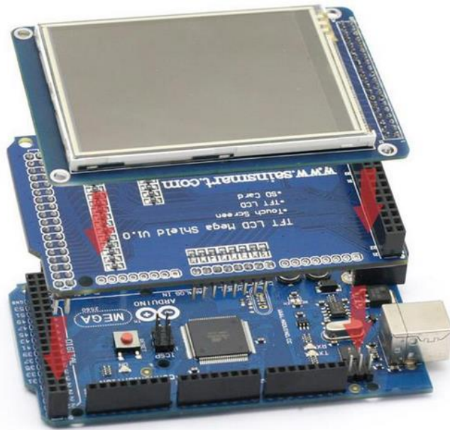
Figura 4.48. Arreglo TFT, shield y Arduino Mega 2560.
