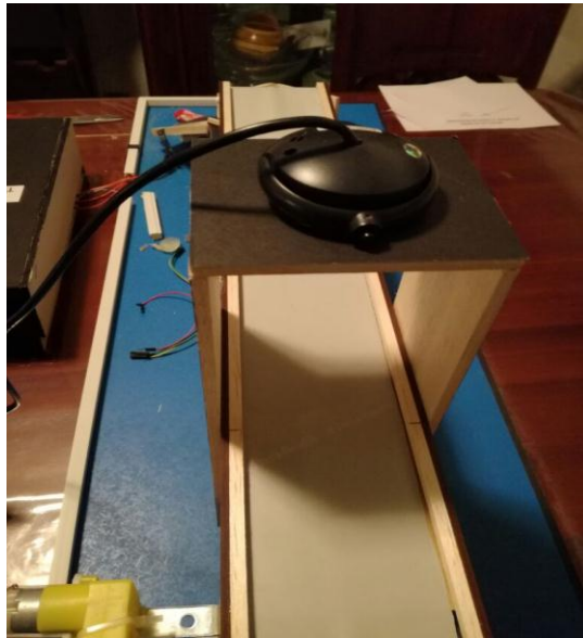
Figura 3.9 Instalación cámara web, parte superior
