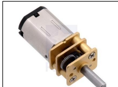
Figura 2.2 Motor Micro Metal Gearmotor H HPCB 6V de marca Pololu
