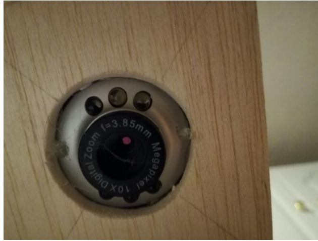
Figura 3.8 Instalación cámara web, parte inferior
