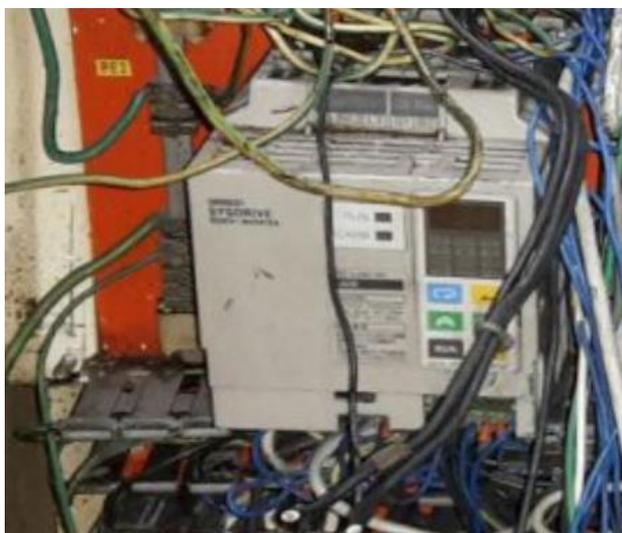
**Figura 3. 18 Variadores de Frecuencia obsoletos de la máquina antigua**
