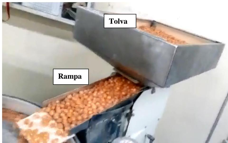
**Figura 3. 3 Proceso de depósito y caída de los caramelos.**
