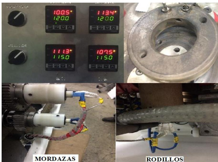
Figura 4. 20 Controles de Temperatura, resistencias calefactoras.
