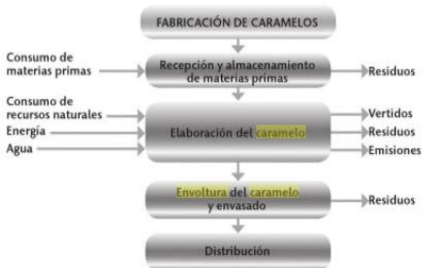
Figura 1. 1 Proceso de Fabricación de Caramelos.
