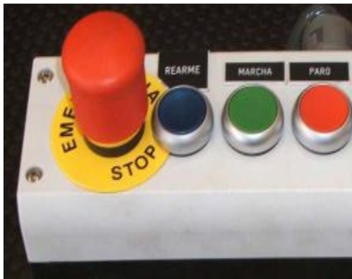
**Figura 1. 21 Panel de Mando operativo en máquinas industriales**
