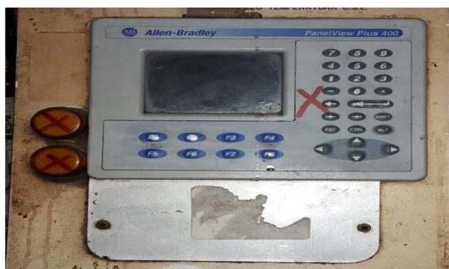
Figura 3. 17 Pantalla HMI obsoleta de la máquina antigua
