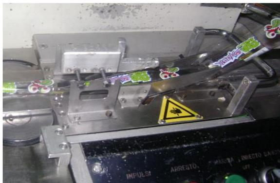
Verificar el sellado longitudinal. Este sistema está compuesto por seis rodillos. El primer par está compuesto por rodillos no calentados y su finalidad es la de arrastrar el tubular manteniéndolo en posición para el sellado que se efectuará por los dos pares sucesivos
