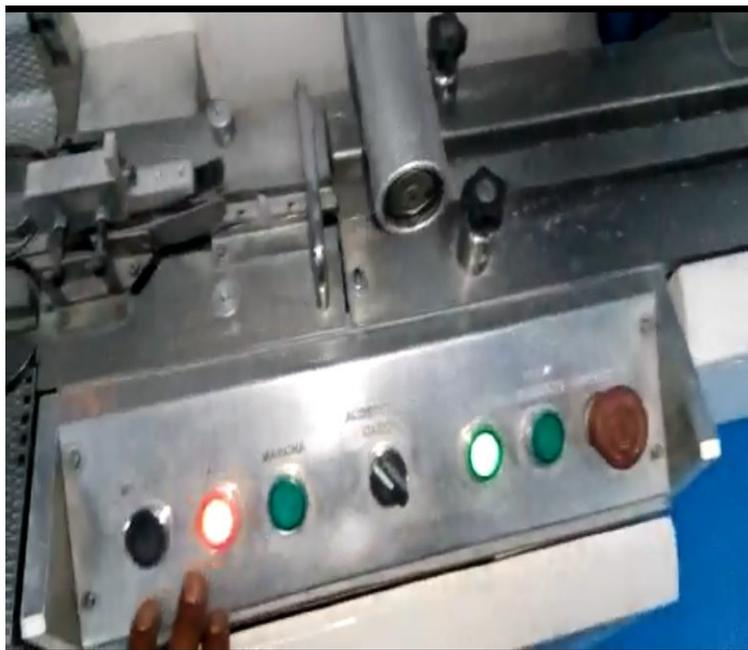
Figura 4. 24 Nueva botonera principal de control de operador
