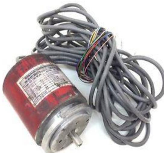
**Figura 3. 19 Encoder Hohner obsoleto de la máquina antigua**
