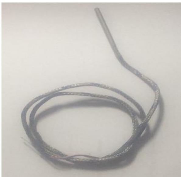
**Figura 3. 21 Termocupla tipo J obsoleta de la máquina antigua**
