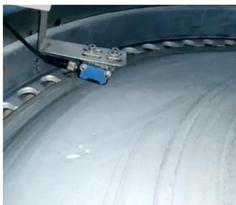
**Figura 3. 5 Proceso de control del sensor Fotoelectrico.**
