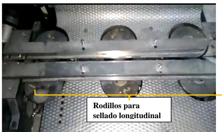
**Figura 3. 8 Rodillos para proceso de sellado longitudinal**
