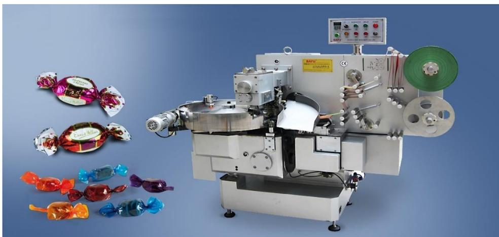
**Figura 1. 3 Máquina moderna para envoltura de caramelos.**
