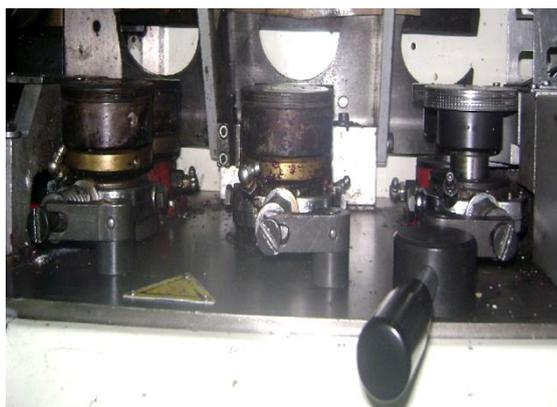
Verificar el sellado transversal y el corte. El sellado transversal y corte del tubular se realiza mediante un par de mordazas.
