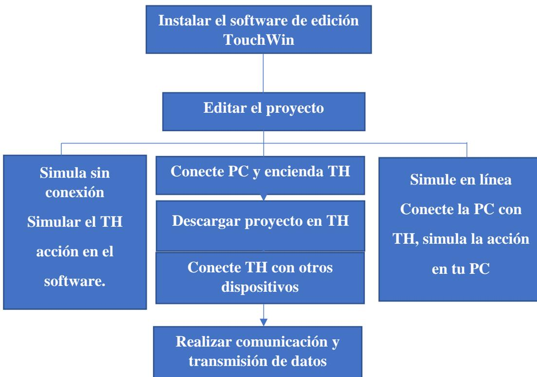
Figura 1. 51 Diagrama de flujo del funcionamiento del Software TouchWin
