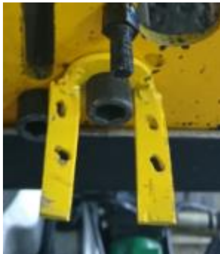
Figura 3.8. Diseño de pieza para fijar encoder.
