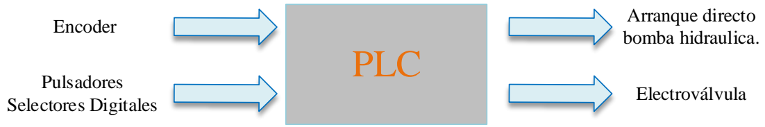
Figura 3.6. Diagrama de entradas/salidas del controlador electrónico PLC
