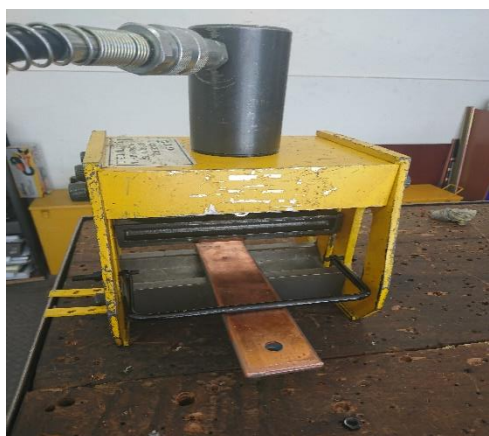
Colocación barra de cobre
