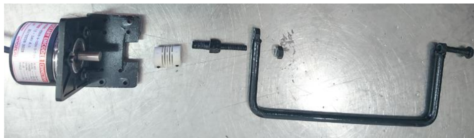
Figura 3.12. Diseño sistema de acoplamiento encoder
