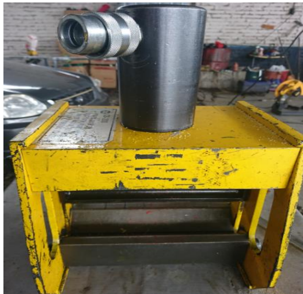
Figura 3.1. Máquina dobladora de barras de cobre.
