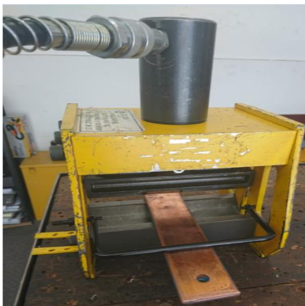
Figura 3.11. Dobladora con barra de cobre y pieza transmisora del ángulo de doblaje
