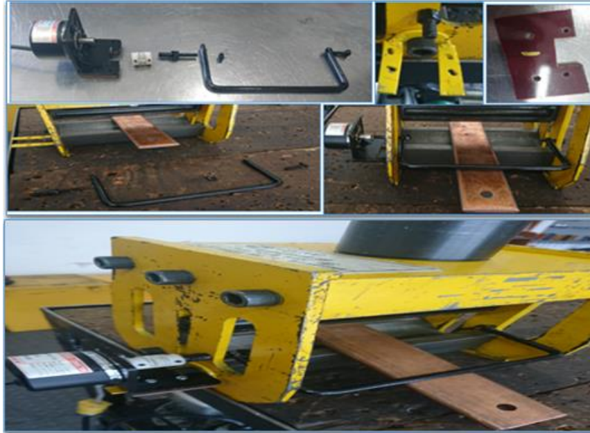
Figura 4.1. Subsistema mecánico de acople del encoder
