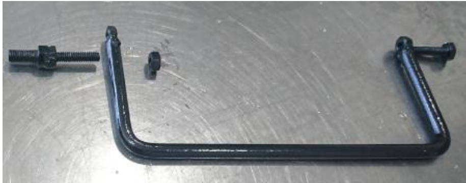
Figura 3.9. Diseño de pieza para acople y lectura para encoder.
