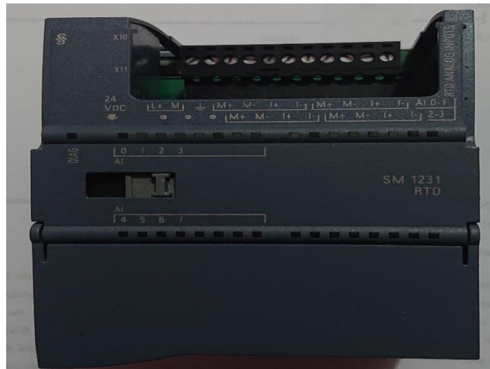
Fig. 3.21 Entradas análogas para RTD's con 8 espacios
