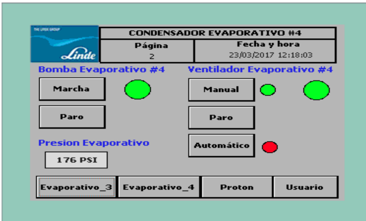
Fig. 3.56 ON/OFF Bomba y ventilador #4
