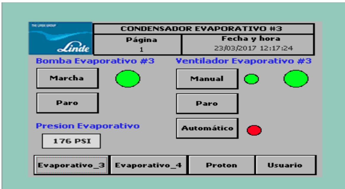
Fig. 3.55 ON/OFF Bomba y ventilador #3
