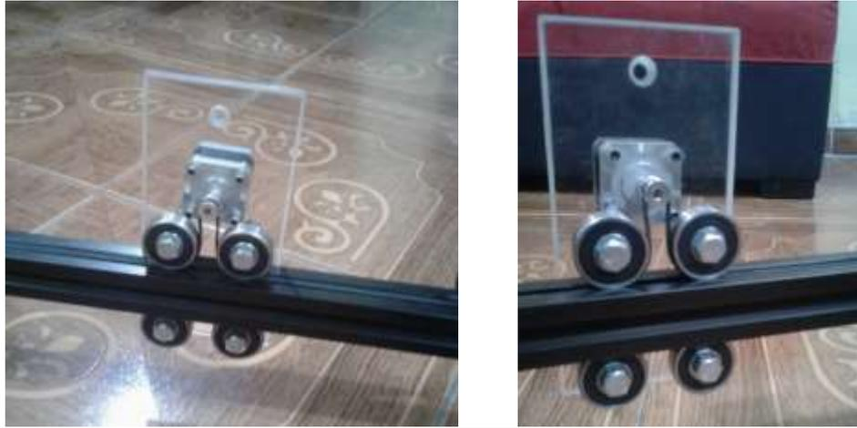
**Figura 4. 13:** Ubicación de los rodamientos del eje Y
