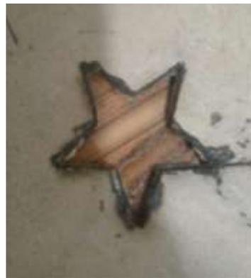
**Figura 4. 50:** Corte en MDF con una velocidad de 300mm/min
