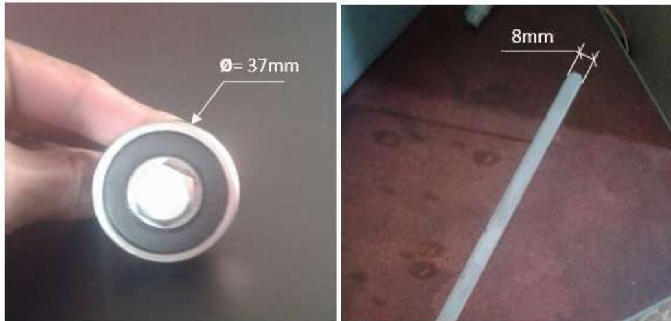
**Figura 4. 6:** Rodamiento y soporte de acrílico
