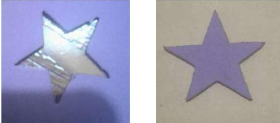
**Figura 4. 52:** Corte en fomix con una velocidad de 800mm/min
