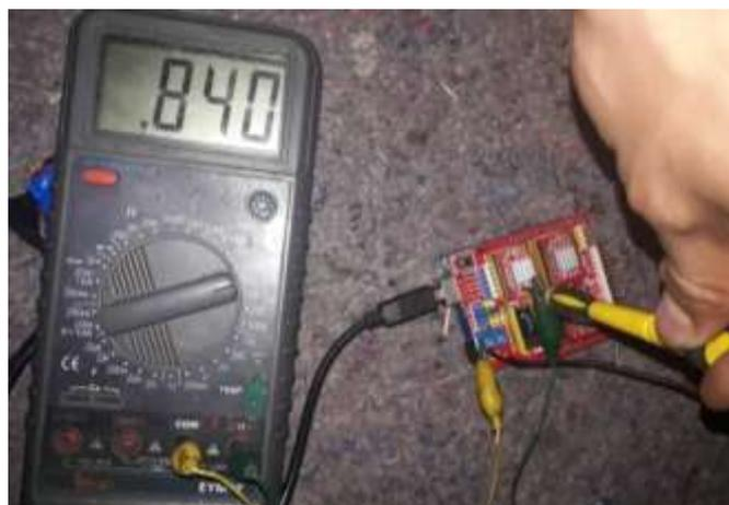
Figura 3. Calibración del Vref
