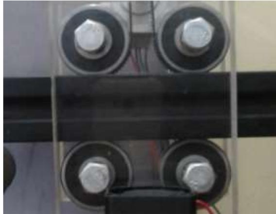
**Figura 4. 8:** Colocación de los rodamientos
