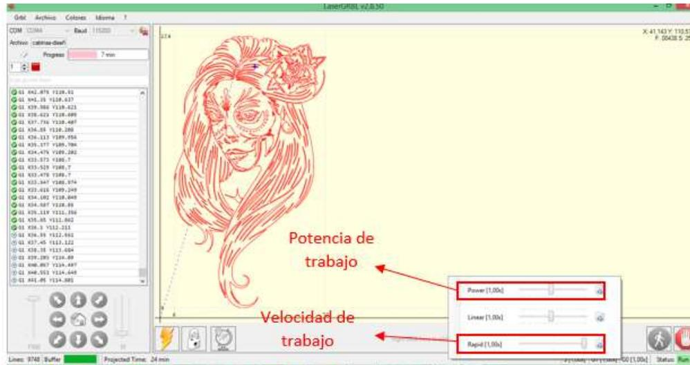
**Figura 4. 42:** Configuración de potencia y velocidad
