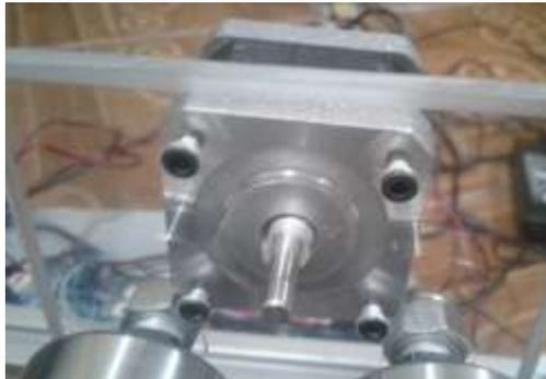
**Figura 4. 15:** Montaje del motor en el soporte
