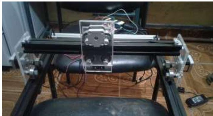
**Figura 4. 11:** Estructura del eje Y
