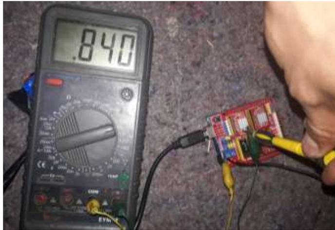
**Figura 4. 24:** Calibración del Voltaje de referencia
