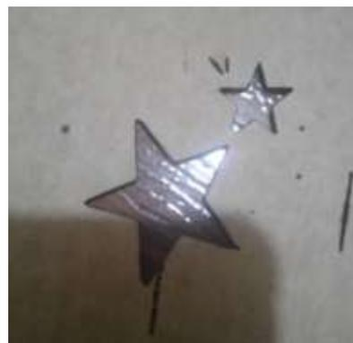
**Figura 4. 51:** Corte en cartón con una velocidad de 600mm/min
