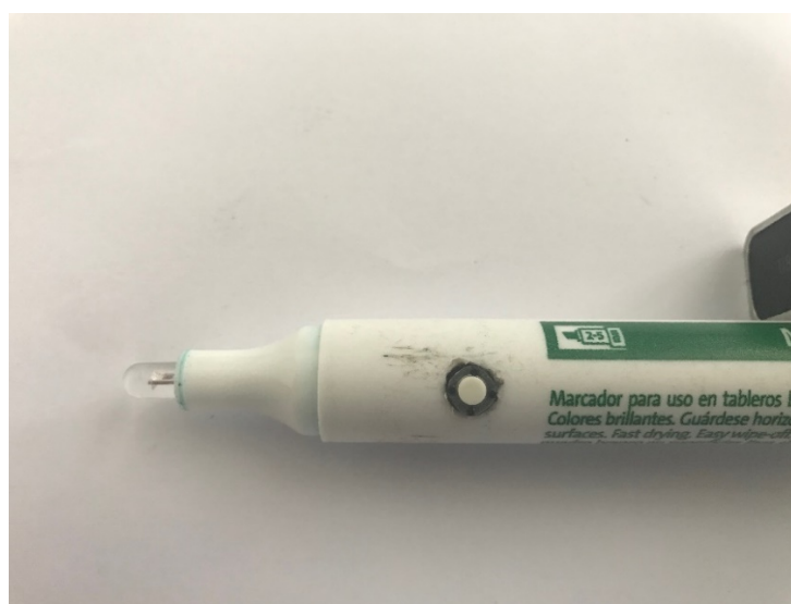
Figura. 3. 17. Punta del marcador, se observa el interruptor pulsador y el LED IR
