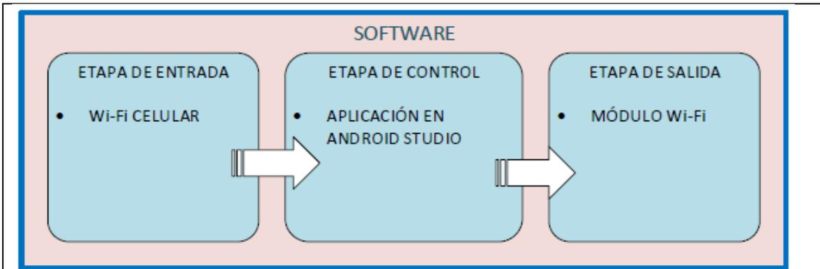
**Figura 5. Diagrama de bloques del *software* del prototipo**
