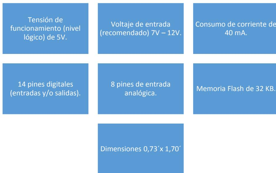
**Figura 1.6 Características de la placa Arduino Nano.**
