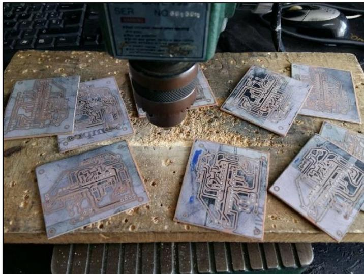
Figura 3.2. Realización de los orificios con el taladro
