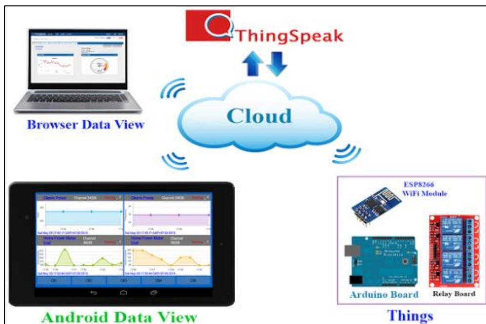
Figura 2.16. Esquema de conexiones de aplicaciones IoT con ThingSpeak
