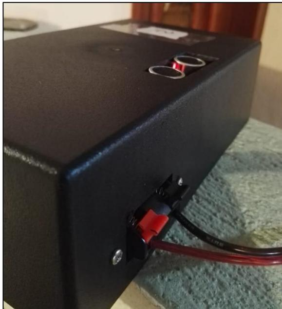
Figura 3.6. Colocación de portajacks tipo hembra para alimentación
