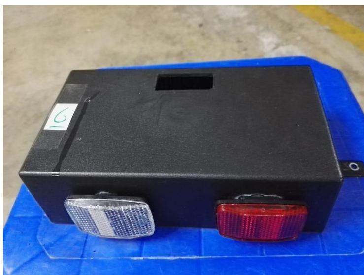
Figura 3.5. Colocación de lunas reflectivas para visualización frontal de la señalización
