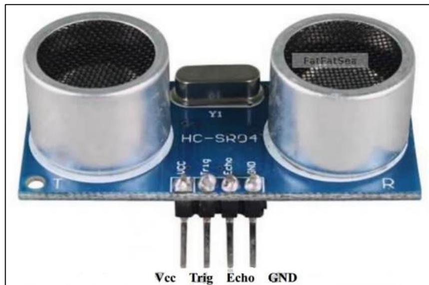
Figura 1.1. Sensor de distancia ultrasónico
