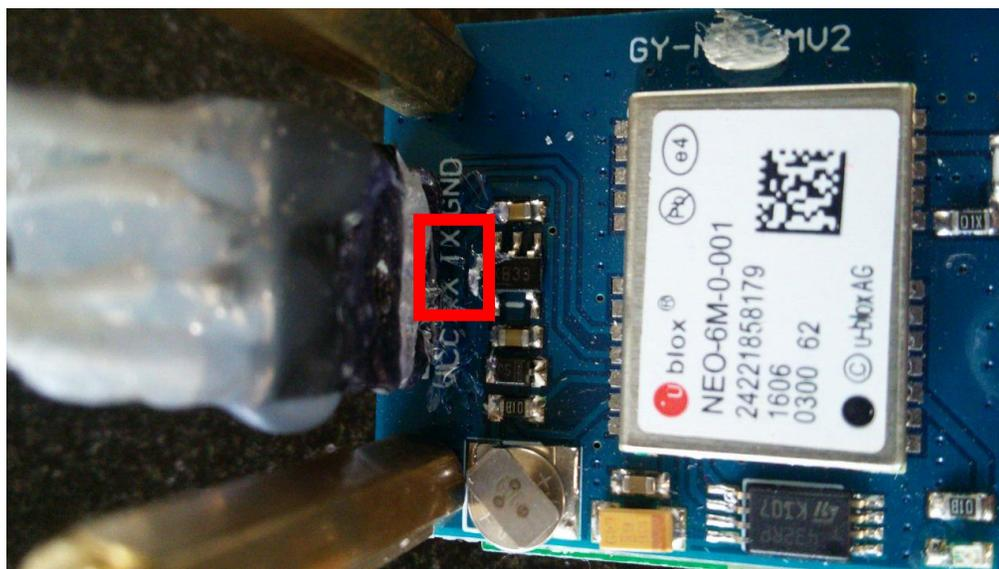
*Figura. 3. 24 Conexión de Bus de datos para Tx y Rx
