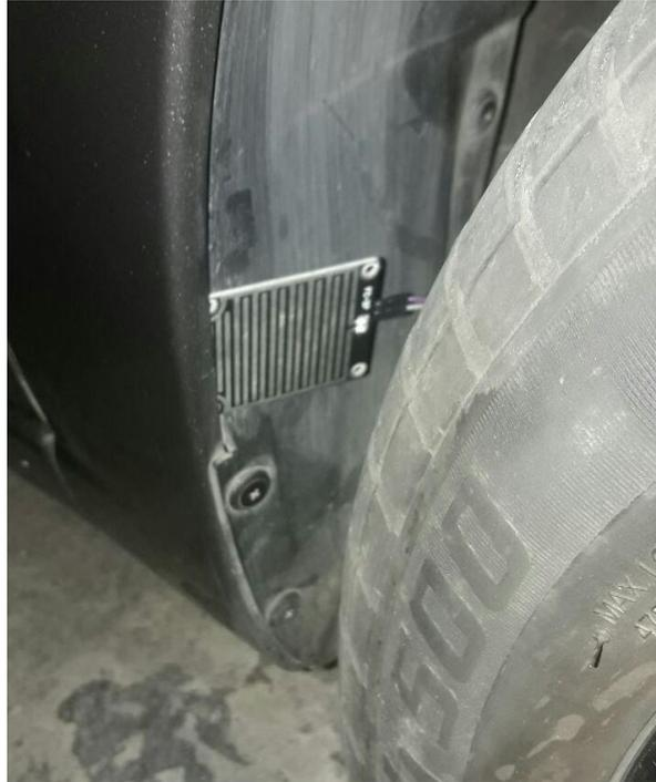
*Figura. 3. 34 Colocación del sensor de agua en el guardalado
