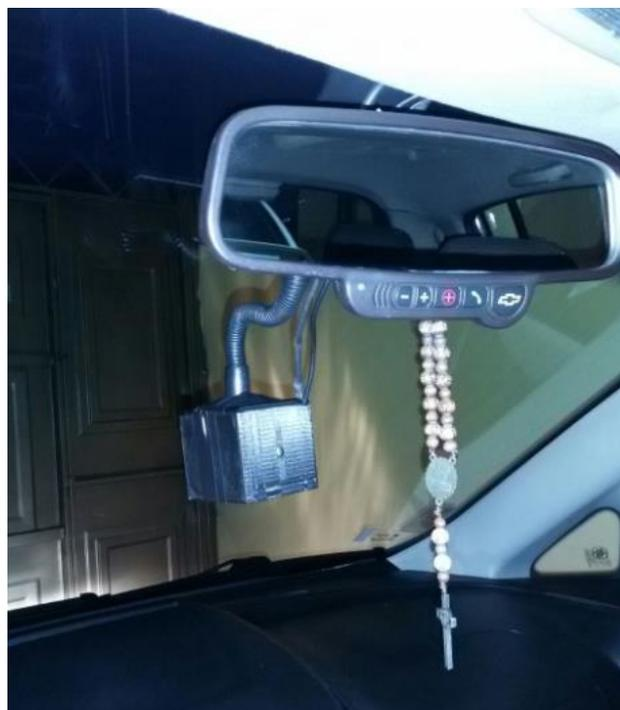
*Figura. 3. 33 Colocación de la Caja de la cámara en el parabrisas
