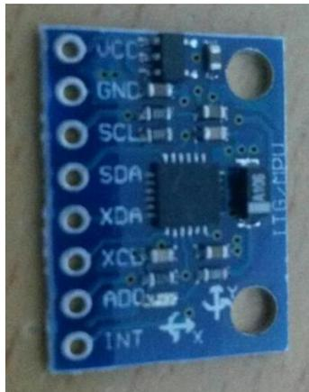
*Figura. 2. 6 Acelerómetro- Giroscopio*
