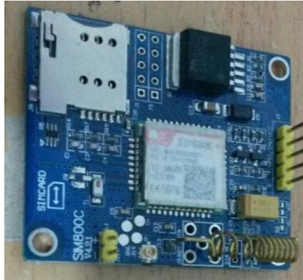
*Figura. 2. 10 Módulo GSM SIM 800*
