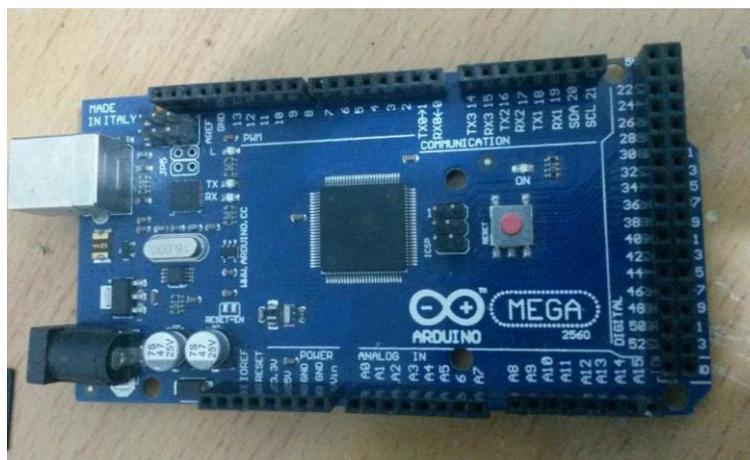
*Figura. 2. 5 Arduino Mega
