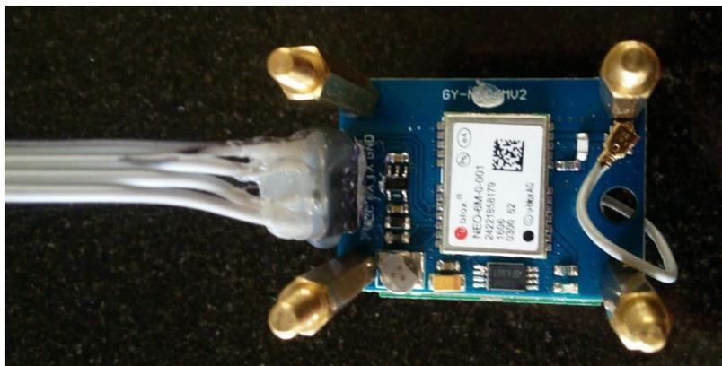
*Figura. 3. 23 Conexión de Bus de datos de 4 Vías
