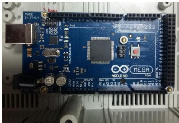
*Figura. 3. 19 Colocación del Módulo Arduino Mega
