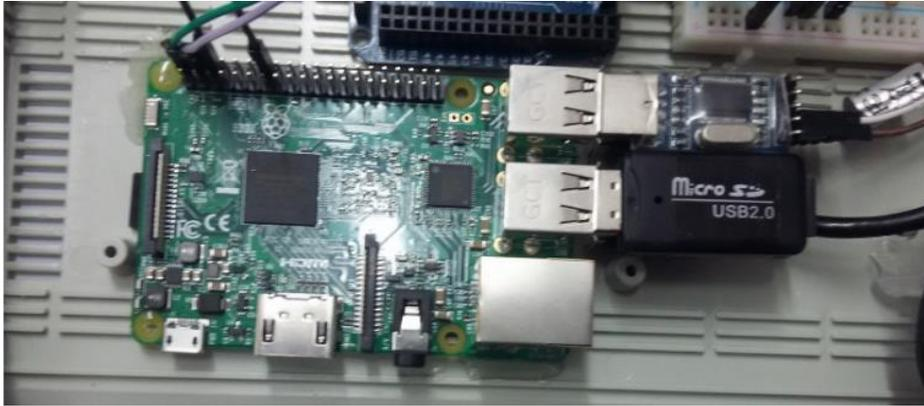
*Figura. 2. 13 Raspberry y Conversor USB Serial
