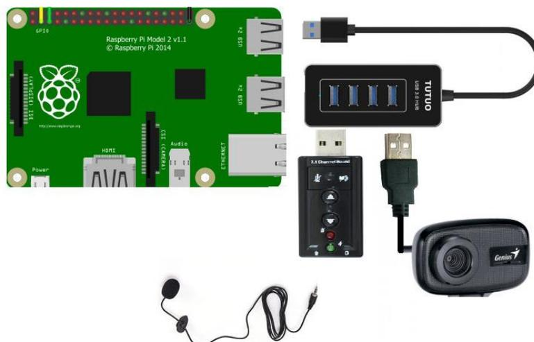
*Figura. 3. 11 Diagrama de conexión de la Raspberry Pi con la Cámara y Micrófono
