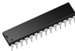
**Figura. 1. 11. Microcontrolador Atmega 328p**
