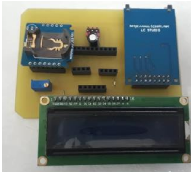
Figura 45. Montaje de RTC y módulo SD
