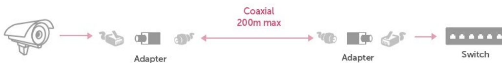
FIGURA 10. RED CON CABLE COAXIAL.
