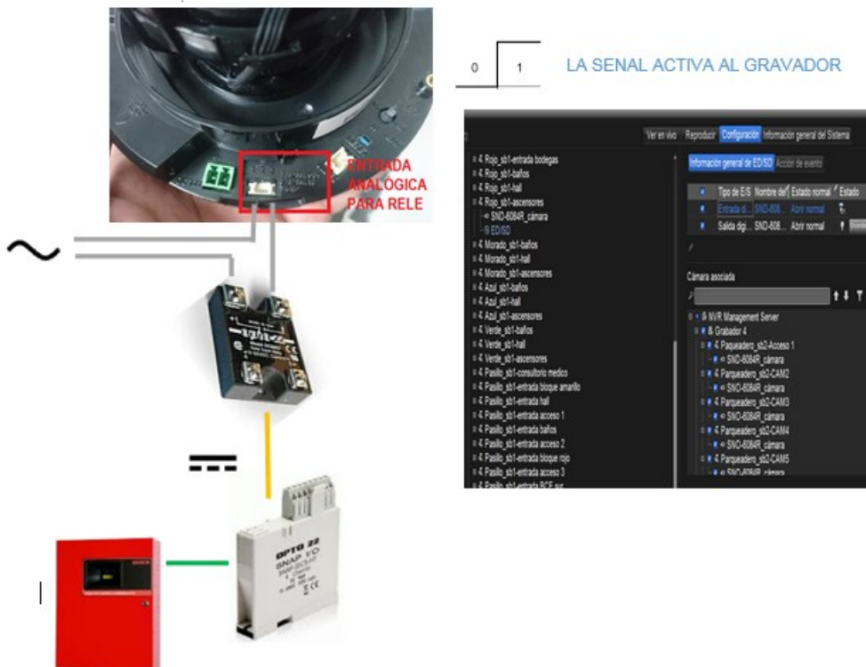
FIGURA 38. CONEXIÓN DE LA ENTRADA ANALÓGICA AL ACCIONAR LA ALARMA DEL CONATO DE INCENDIOS. Fuente: AUTOR.
