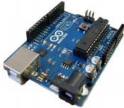
Figura 11. Arduino UNO con microcontrolador en formato DIP. Fuente: Elektronika. Voor jou (2018).
