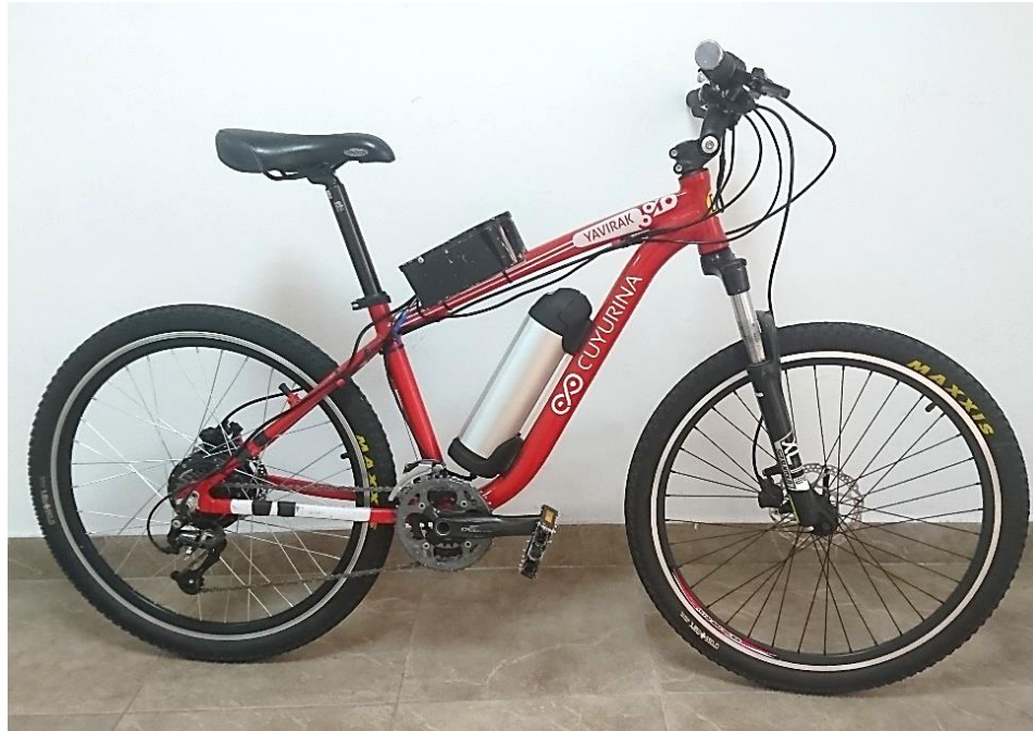
Figura 26. Implementación de la Batería en la bicicleta. Fuente: Elaborado por el autor.
