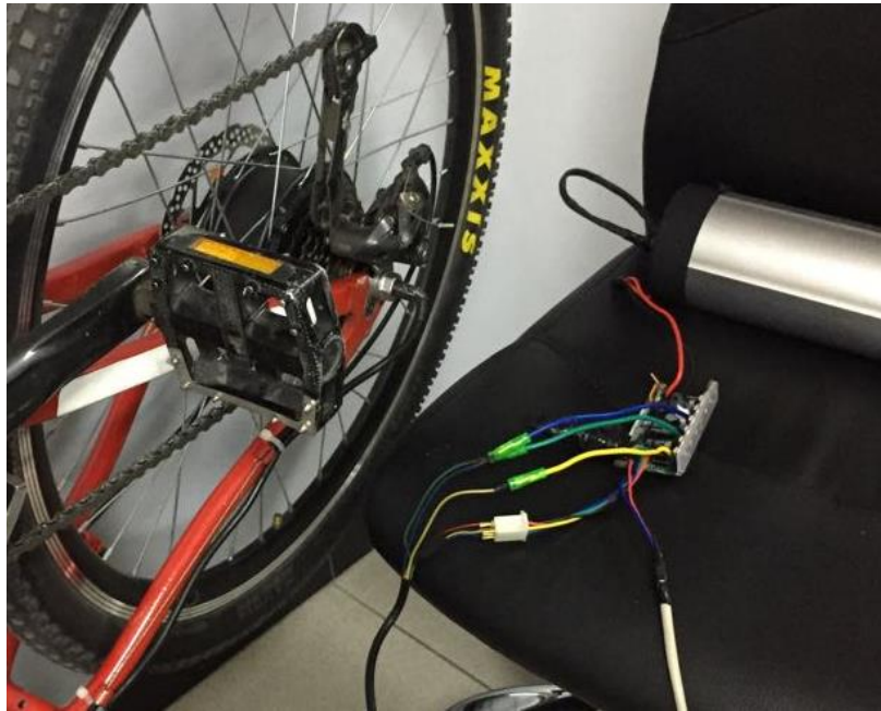
Figura 28. Circuito de Potencia que permite mover el motor. Fuente: Elaborado por el autor.
