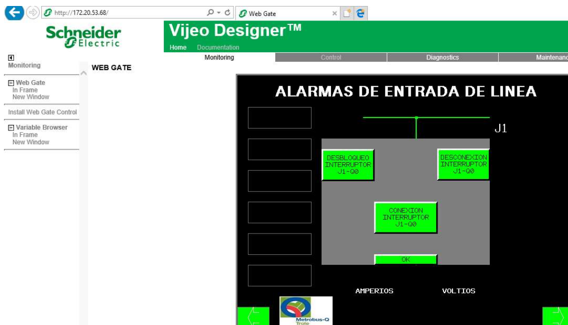
Figura 3.87. Opciones de Conexión y Desconexión de Q0.
