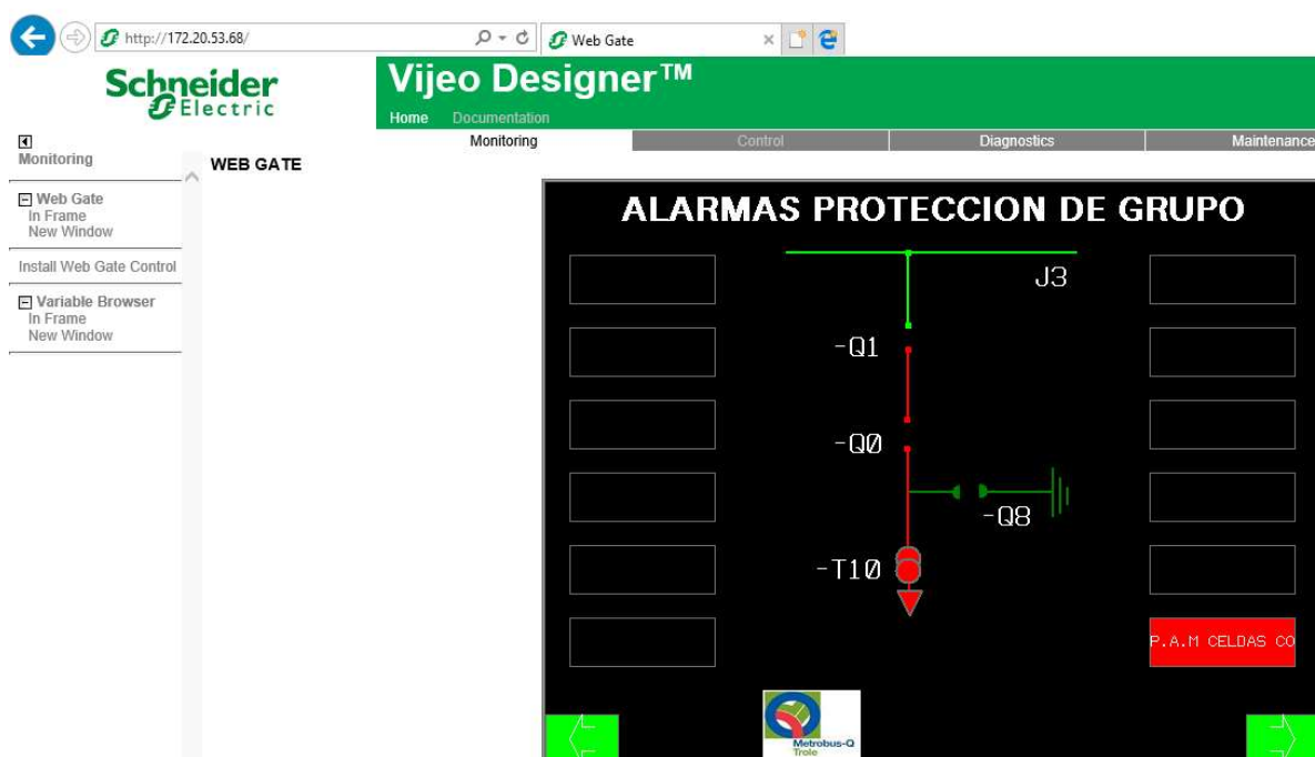
Figura 3.88. Estado de Conexión de J3.
