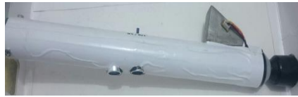
Figura 82. Colocación del circuito en el bastón.
