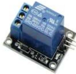
**Figura 15.** Módulo Relé para Arduino. (Electrónicos Caldas, 2016)
