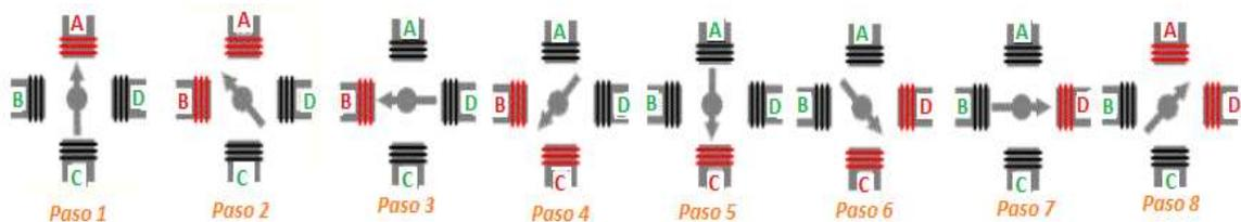
**Figura 9.** Movimiento del rotor indicando la secuencia de medio paso. (Gonzáles, 2002)
