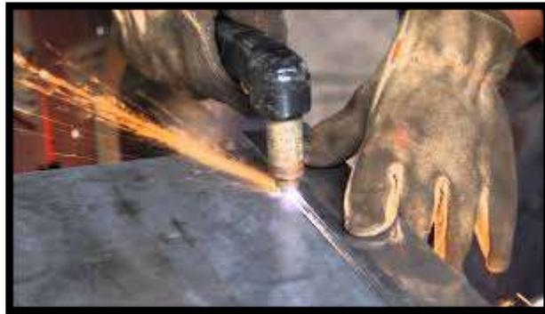
**Figura 18.** Corte manual con plasma (Codinter, 2018)
